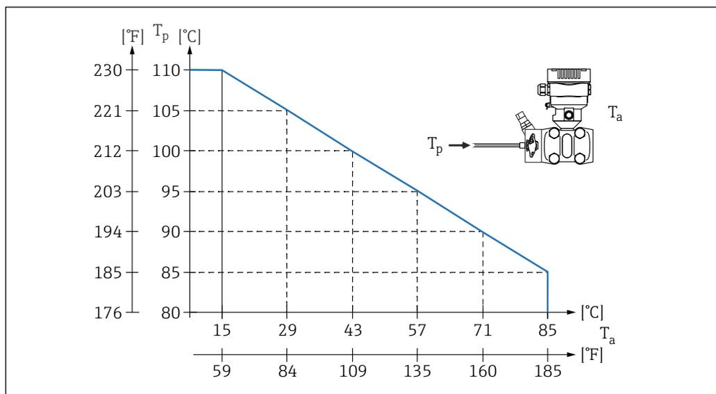
$T_a$  Максимальная температура окружающей среды на вентиляльном блоке
