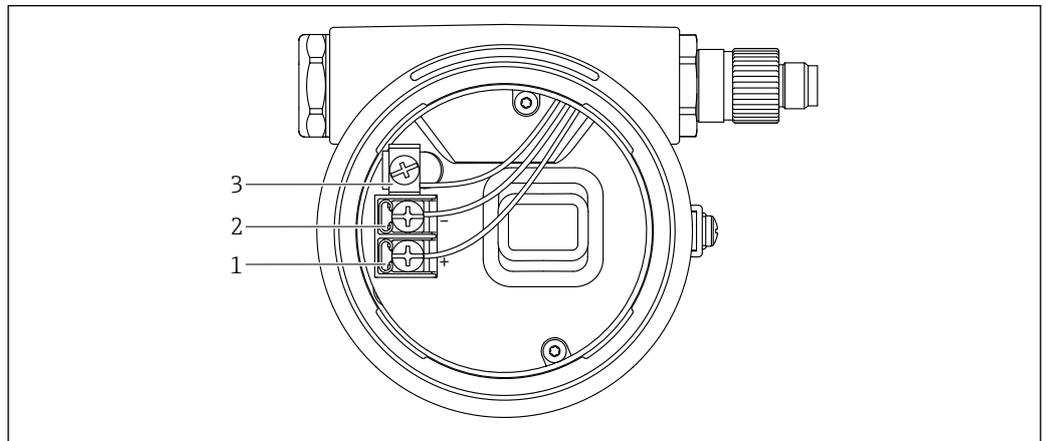
1 Соединительные клеммы и клемма заземления в клеммном отсеке
