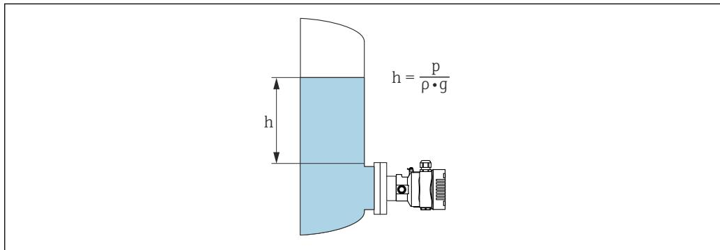
*h Высота (уровень)**p Давление**ρ Плотность среды**g Гравитационная постоянная***Измерительный прибор с разделительной диафрагмой**
