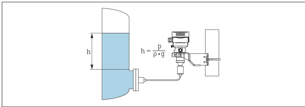
**■ 1 Образец на иллюстрации: разделительная диафрагма с капилярной трубкой***h Высота (уровень)**p Давление**ρ Плотность среды**g Гравитационная постоянная***Преимущества**
