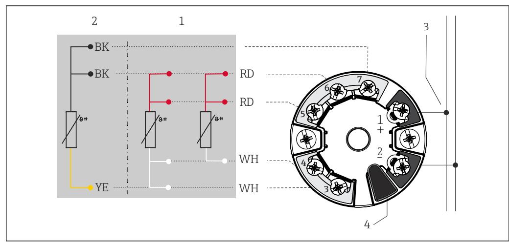
■ 6 Преобразователь в головке датчика TMT8x (двойной вход)
