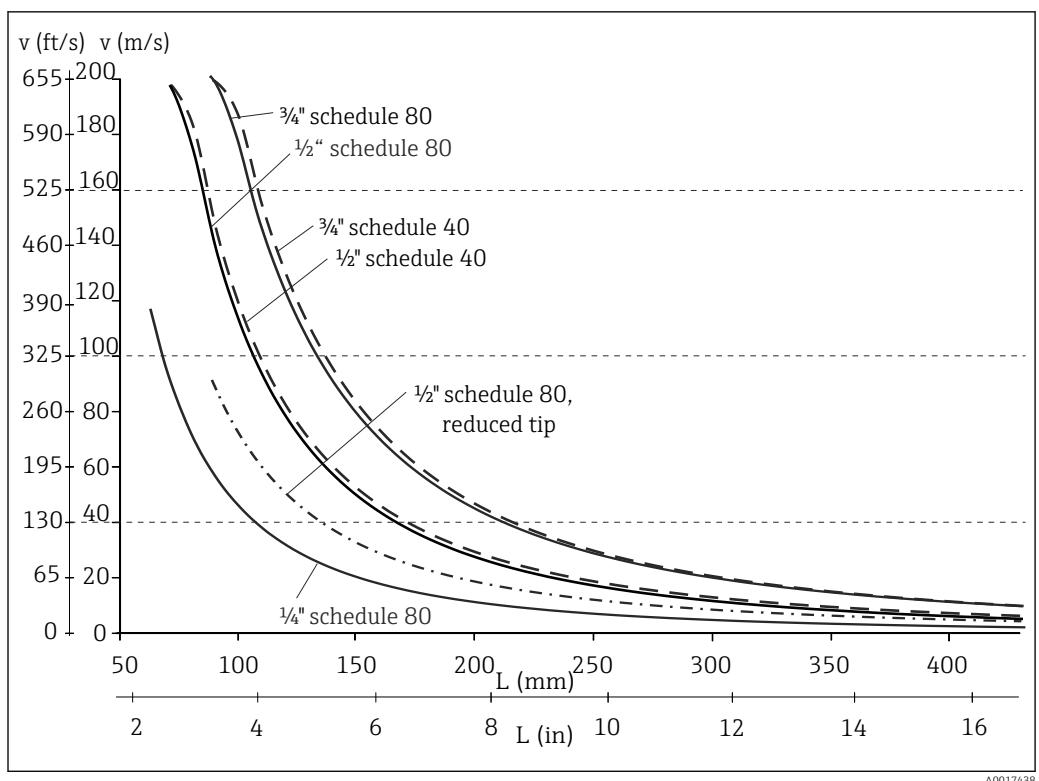
■ 14 Допустимые значения скорости потока для термометров разных диаметров в технологической среде (перегретом паре) при температуре  $T = 400^{\circ}\text{C}$  ( $752^{\circ}\text{F}$ )
