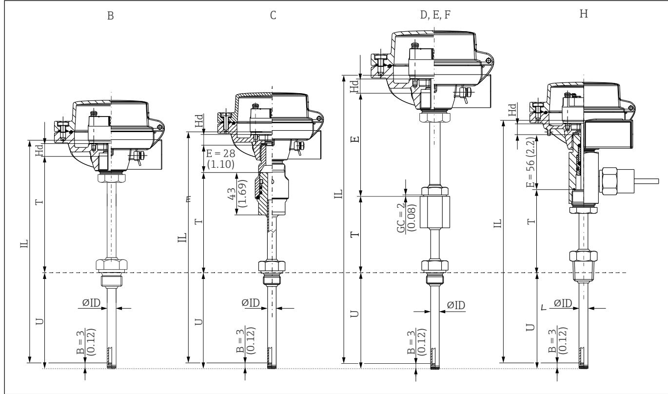
18 В термометрах такого исполнения используется вставка TS111 с шайбой.
