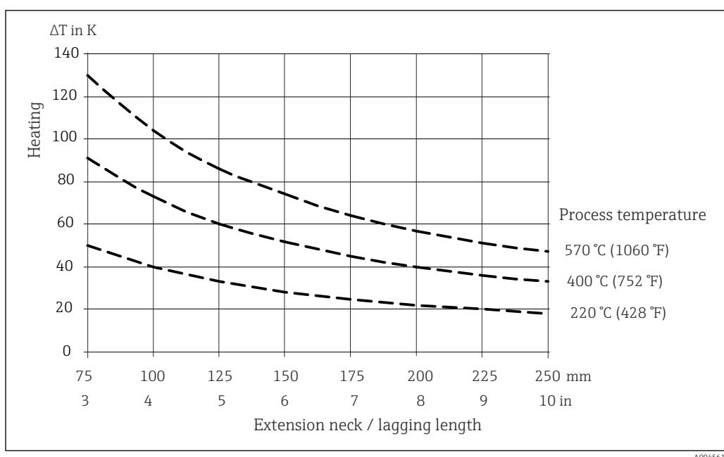
■ 25 Нагрев присоединительной головки в зависимости от рабочей температуры. Температура в присоединительной головке = температура окружающей среды 20 °C (68 °F) +  $\Delta T$
