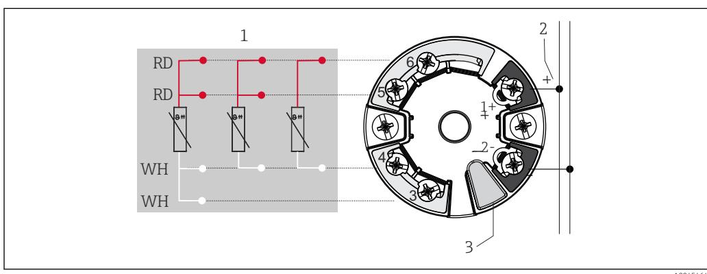
■ 5 Преобразователь TMT7x в головке датчика (один вход)
