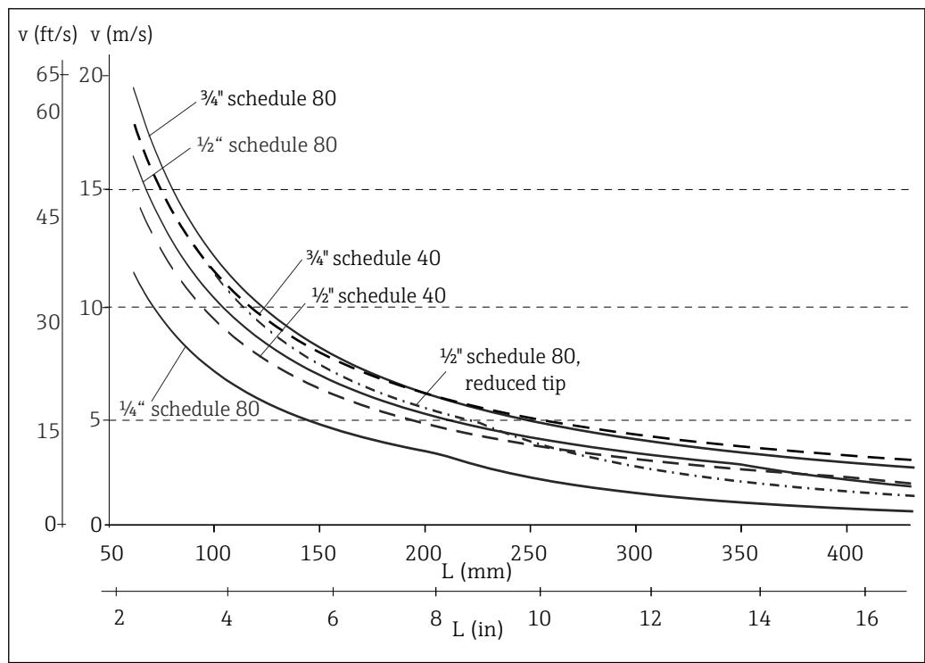
■ 13 Допустимые значения скорости потока для термометров разных диаметров в технологической среде (воде) при температуре  $T = 50^\circ\text{C}$  (122 °F)
