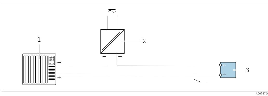
■ 8 Пример подключения для релейного выхода (пассивного)
