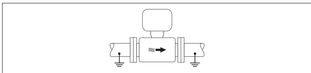
■ 13 Выравнивание потенциалов с использованием измерительной трубы
