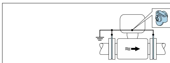
■ 15 Выравнивание потенциалов, реализованное с помощью заземляющей клеммы и колец заземления
