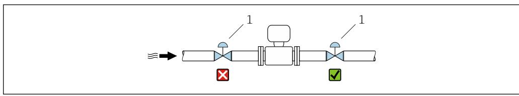
■ 19 Не рекомендуется монтаж датчика после регулирующего клапана
