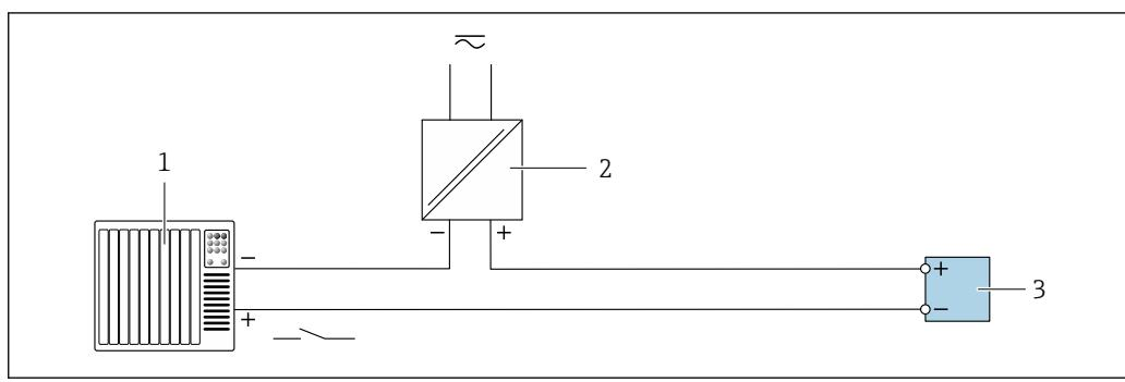
■ 12 Пример подключения для входного сигнала состояния
