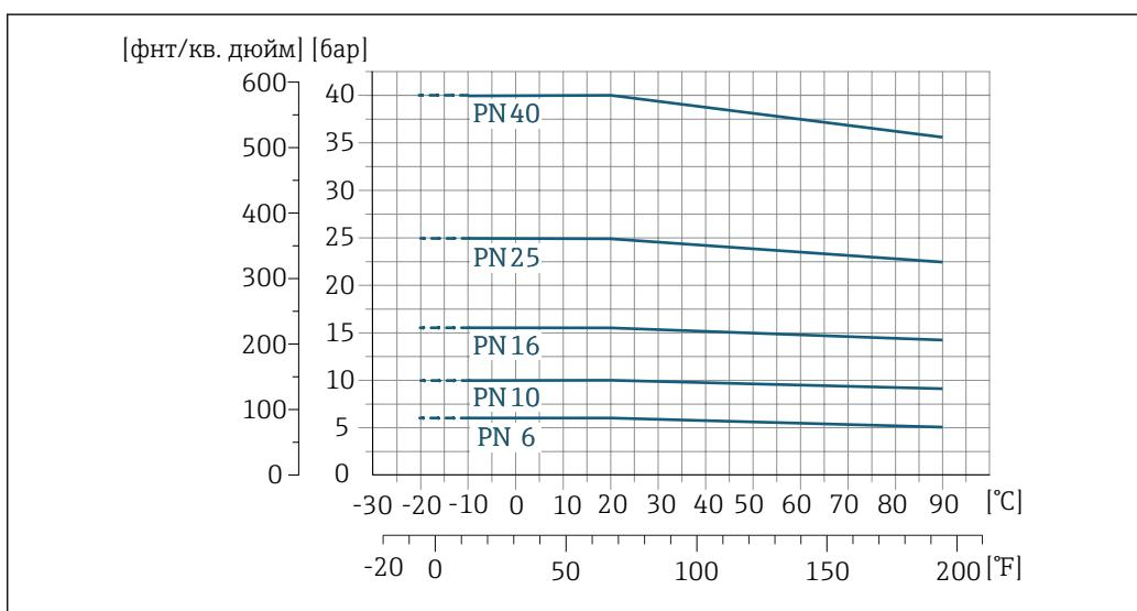
25 Материал присоединения к процессу: нержавеющая сталь ( $-20$   $^{\circ}\text{C}$  ( $-4$   $^{\circ}\text{F}$ )); углеродистая сталь ( $-10$   $^{\circ}\text{C}$  ( $14$   $^{\circ}\text{F}$ ))
