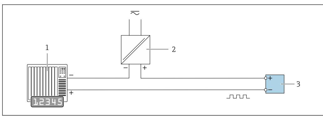
■ 7 Пример подключения для импульсного/частотного выхода (пассивного)
