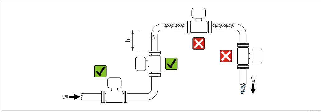
Предпочтителен монтаж датчика в восходящей трубе. Убедитесь в том, что до следующего изгиба трубы соблюдается достаточное расстояние:  $h \geq 2 \times DN$ .
