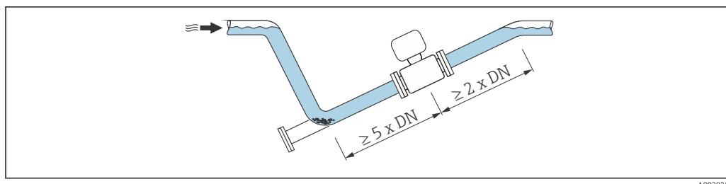
Для тяжелых датчиков  $\text{DN} \geq 350$  (14 дюймов)
