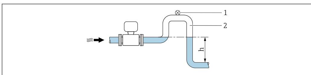
■ 20 Монтаж в спускном трубопроводе
