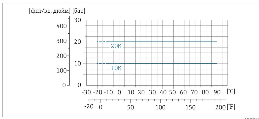
■ 28 Материал присоединения к процессу: нержавеющая сталь ( $-20^{\circ}\text{C}$  ( $-4^{\circ}\text{F}$ )); углеродистая сталь ( $-10^{\circ}\text{C}$  ( $14^{\circ}\text{F}$ ))
