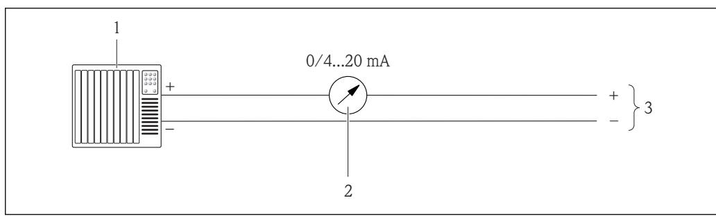
■ 6 Пример подключения для токового выхода 0-20 mA (активного) и токового выхода 4-20 mA (активного)
