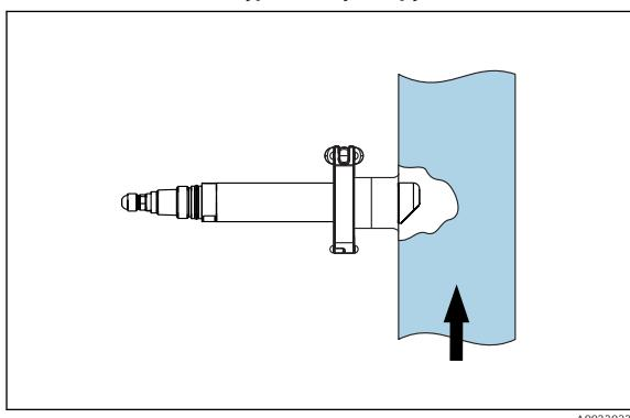
■ 16 Монтаж с помощью зажимного соединения 2 дюйма
