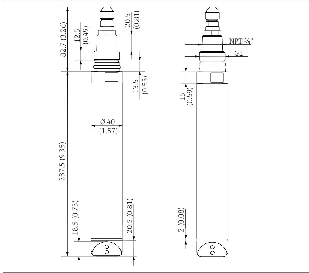
22 Размеры пластмассового датчика. Размеры в мм (дюймах)
