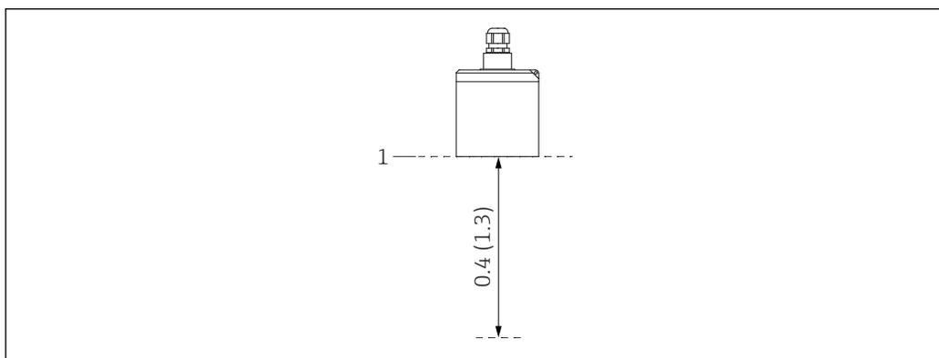
1 Блокирующая дистанция ультразвукового датчика. Единицы измерения – метры (футы)
