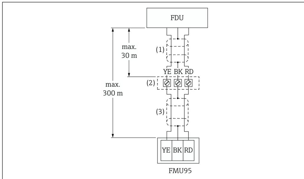
4 Схема подключения датчика. YE – желтый. BK – черный. RD – красный. BU – синий. BN – коричневый. Защитный проводник GNYE – желто-зеленый
