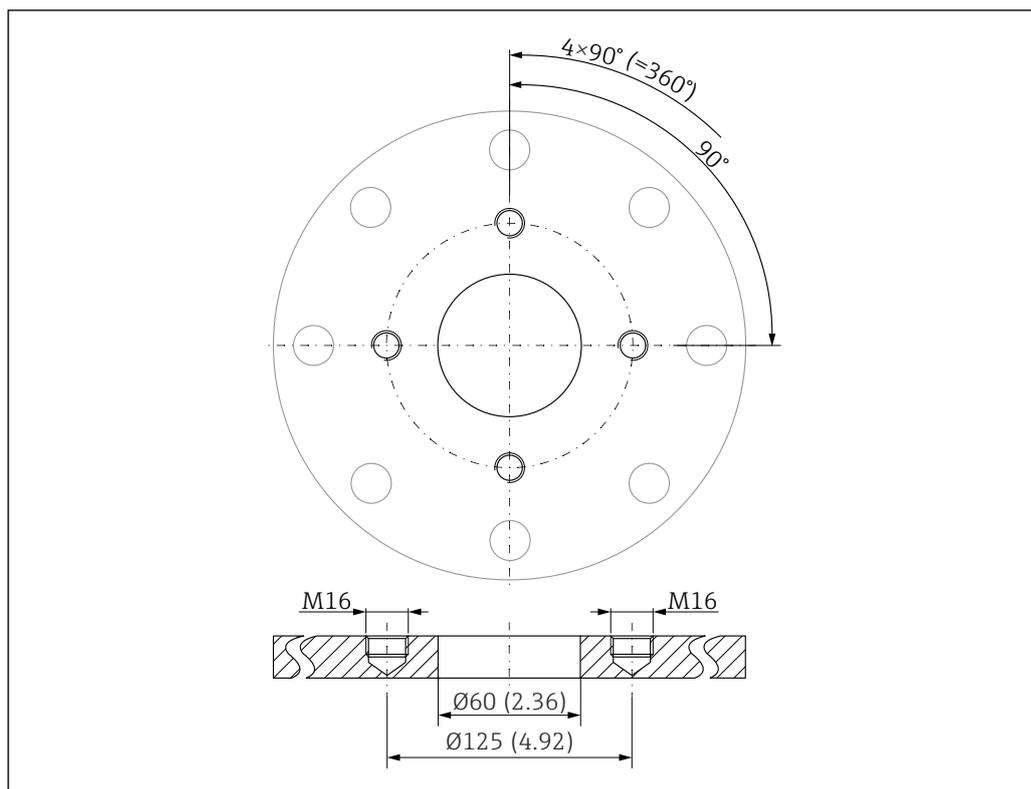
2 Требуется механическая обработка промежуточного фланца. Единица измерения мм (дюйм)
