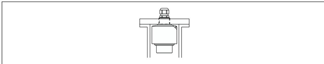
7 Закрепление ультразвукового датчика, монтируемого с помощью контргайки
