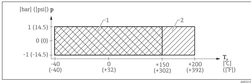
**■ 20 FMR67: допустимый диапазон рабочей температуры и рабочего давления, антенна, PTFE, DN80, фланец UNI 316L**
