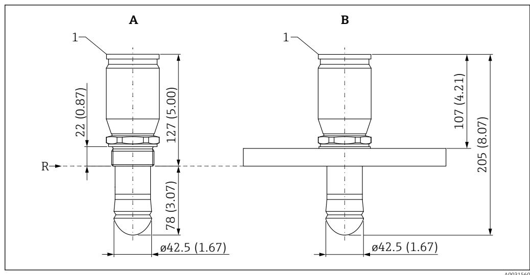
■ 25 Размеры антенны с защитой от конденсата, без присоединения для продувки. Единица измерения мм (дюйм)
