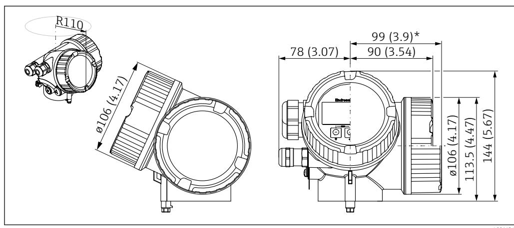
■ 23 Корпус GT19 (пластмасса PBT). Единица измерения мм (дюйм)
