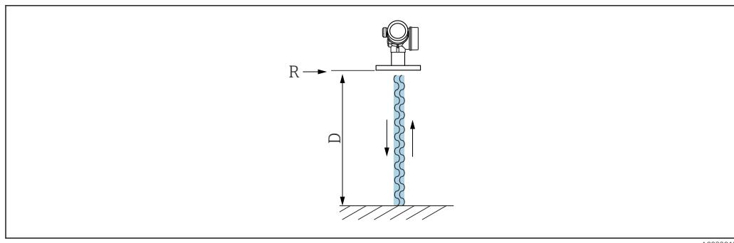
■ 1 Принцип FMCW: излучение и отражение непрерывной волны
