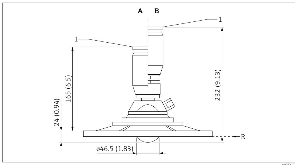
32 Размеры антенны с фланцем UNI, приспособлением для выравнивания и присоединением для продувки. Единица измерения мм (дюйм)
