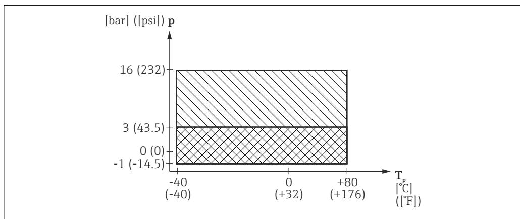
■ 18 FMR67: допустимый диапазон температуры процесса и рабочего давления, антenna с защитой от конденсата, PTFE, DN50
