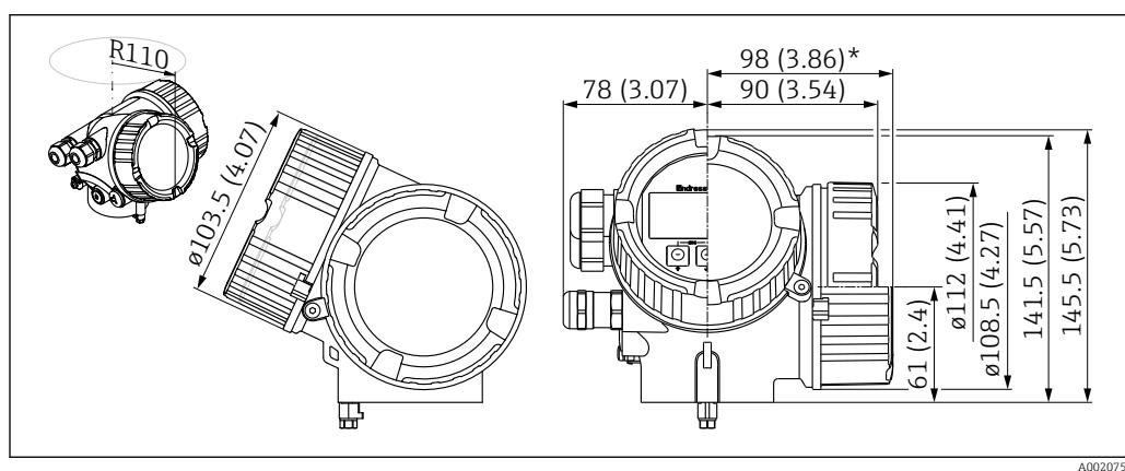
■ 24 Корпус GT20 (алюминий с покрытием). Единица измерения мм (дюйм)
