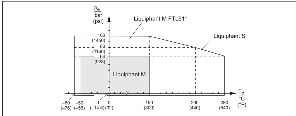
\* Прибор FTL51 со скользящей муфтой для работы в условиях высокого давления (100 бар (1450 psi)). См. раздел «Дополнительная опция» ??????? 46 ? ????, опция P или R.1
