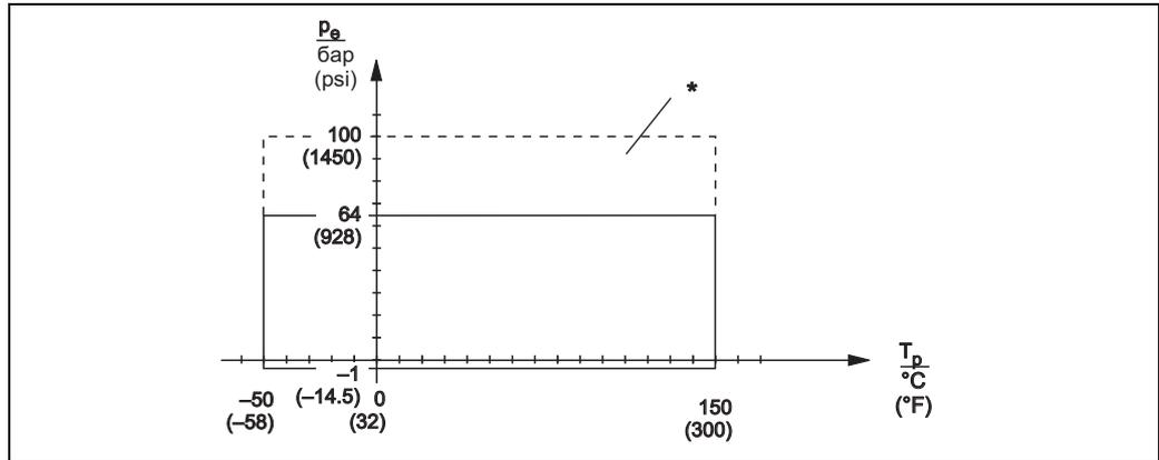
\* Допустимое номинальное давление при выборе опции «100 бар (1450 psi)» (см. раздел «Спецификация прибора FTL51», позиция 060, от → 46).
