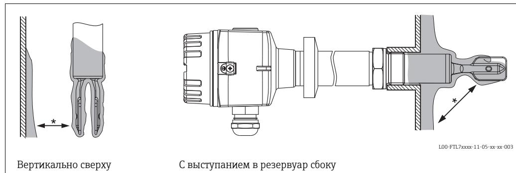
**Монтажные положения при низкой вязкости (до 2000 мм<sup>2</sup>/с (cСт)):**
