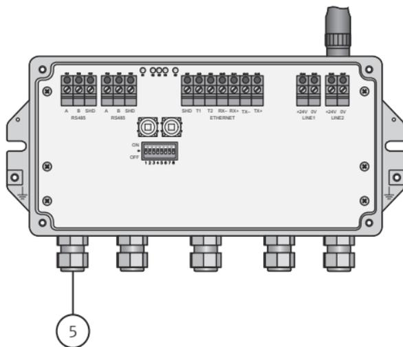
⑥ Теперь шлюз подключен к сети RS-485. Если питание включено, желтый светодиод состояния связи по сети RS-485 (S.COM) начинает мигать при передаче или приеме сообщения HART или Modbus.
