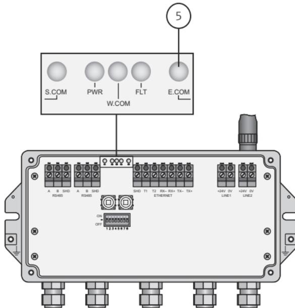
⑤ Теперь шлюз подключен к сети Ethernet. Если питание включено, желтый светодиод состояния связи по сети Ethernet (E.COM) начинает мигать при передаче сообщения HART (см. руководство ВА00064).
