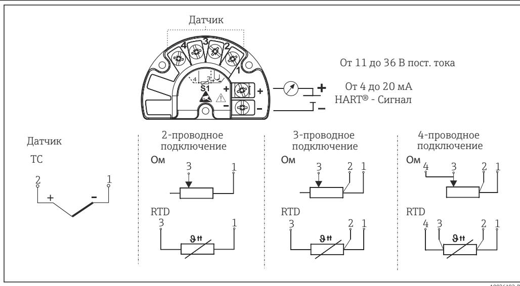
■ 3 Электромонтаж преобразователя
