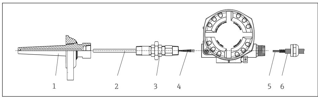
**■ 5 Монтаж полевого преобразователя непосредственно на датчике**
