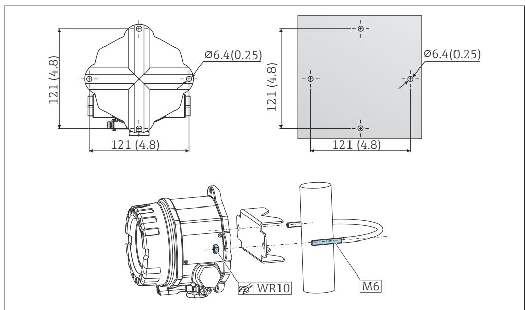
**■ 6 Порядок монтажа преобразователя в полевом корпусе на стену или трубу с помощью 2-дюймового кронштейна для трубного монтажа, приобретаемого в качестве аксессуара, см. в разделе «Аксессуары». Размеры в мм (дюймах)**
