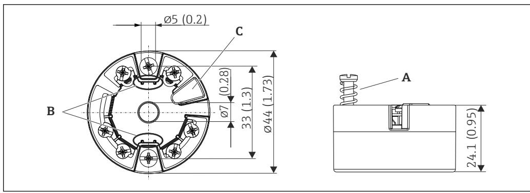
■ 6 Исполнение с винтовыми клеммами
