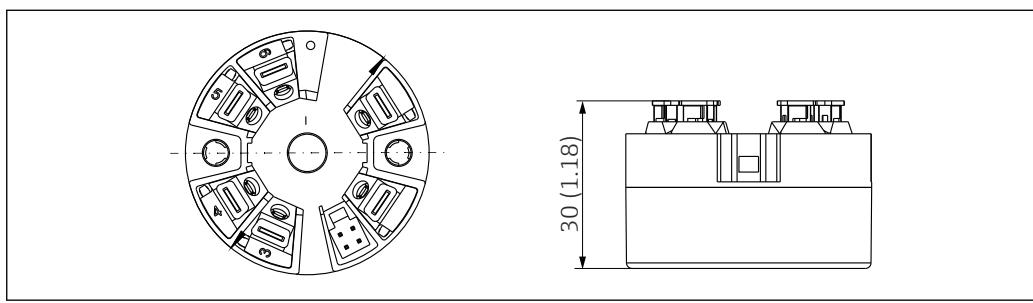
■ 7 Исполнение со вставными клеммами. Те же размеры, что и для исполнения с винтовыми клеммами, за исключением высоты корпуса
