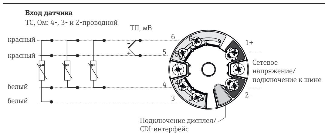
■ 3 Назначение клемм преобразователя в головке датчика
