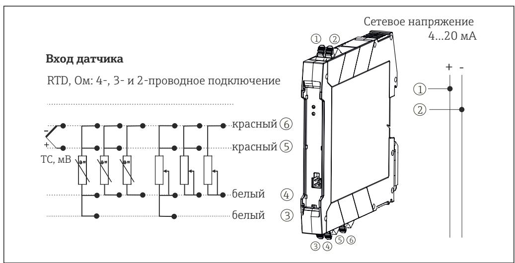
■ 4 Назначение клемм преобразователя, монтируемого на DIN-рейку
