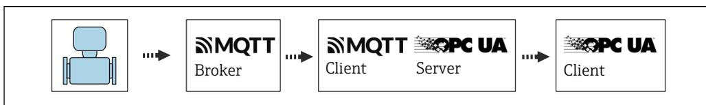
2 Сотовая радиосвязь через брокер MQTT и сервер OPC UA, с шифрованием типа TLS
