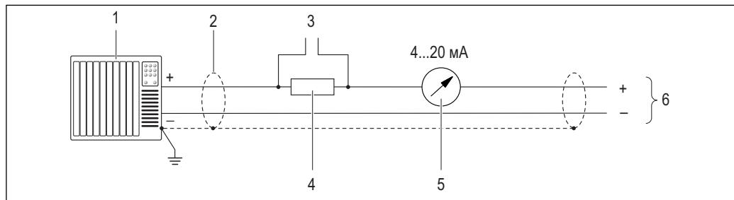
■ 2 Пример подключения для активного токового выхода 4-20 mA
