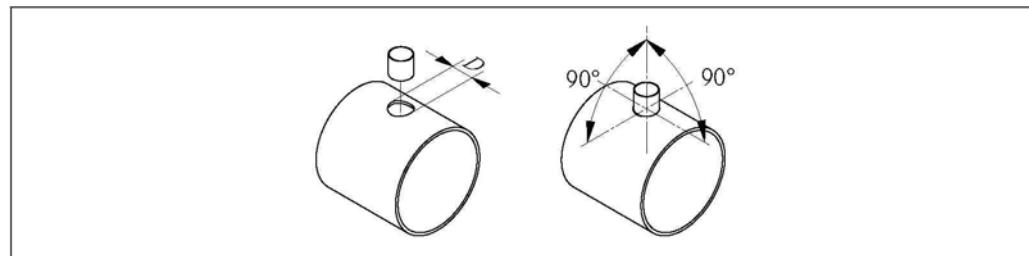
$D = 31,0 \text{ мм} \pm 0,05 \text{ мм}$  (1,22 дюйма  $\pm 0,02$  дюйма)
