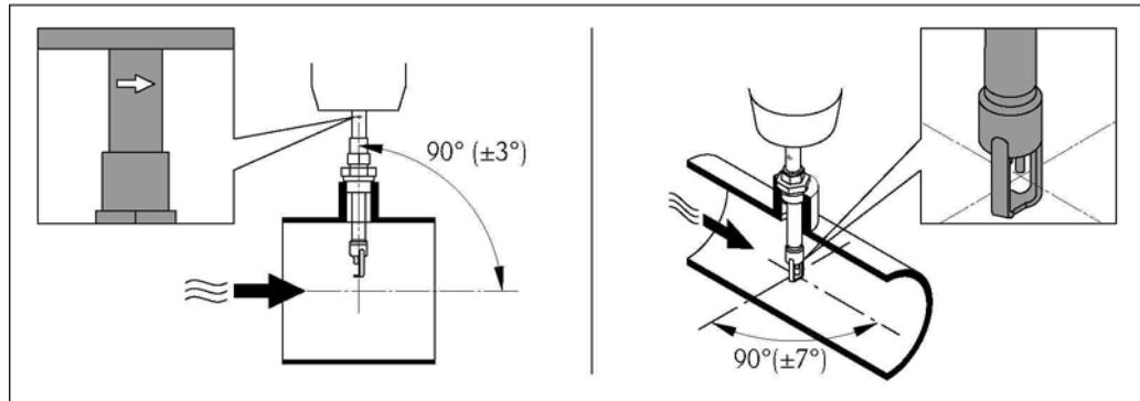
Проверьте и убедитесь, что датчик на трубе/канале установлен под углом  $90^\circ$  к направлению потока. Поверните датчик так, чтобы направление стрелки на его корпусе совпадало с направлением потока. Линия, нанесенная на корпус для корректировки глубины врезки, должна быть параллельна направлению потока.
