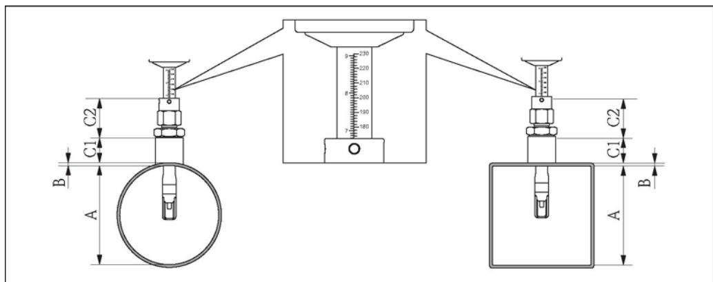
A Внутренний диаметр трубы DN (труба круглого сечения) или внутренний размер (прямоугольный канал)
