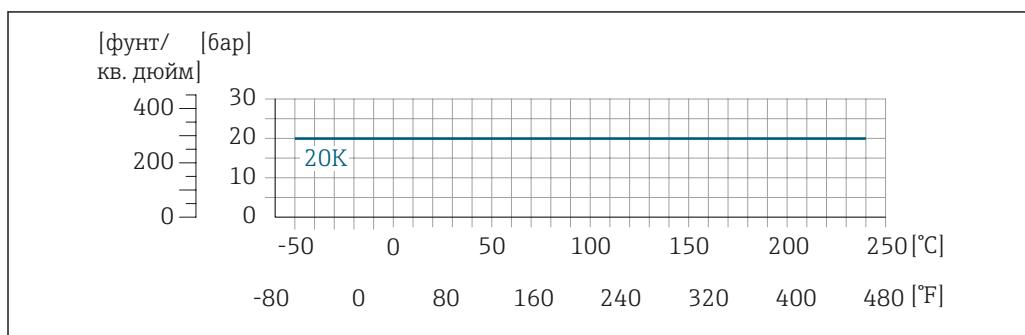
■ 31 С материалом фланца 1.4301 (F304); смачиваемые части: сплав Alloy C22
