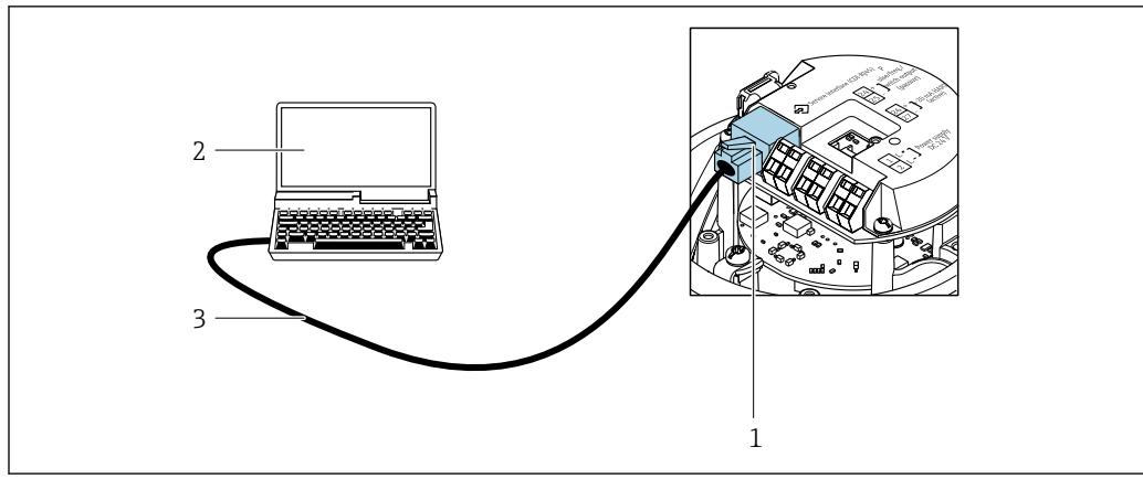
■ 45 Подключение для кода заказа «Выход», опция **B**: 4–20 мА HART, импульсный/частотный/переключающий выход
