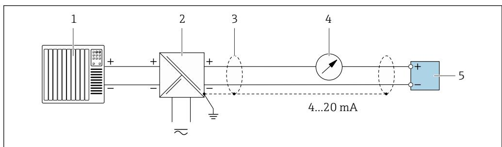
■ 10 Пример подключения для токового выхода 4–20 mA HART (пассивного)
