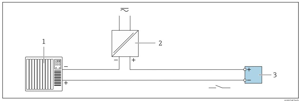
■ 12 Пример подключения для релейного выхода (пассивного)
