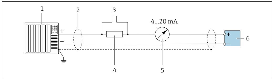
■ 9 Пример подключения токового выхода 4–20 mA HART (активного)
