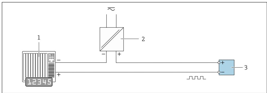
■ 11 Пример подключения для импульсного/частотного выхода (пассивного)
