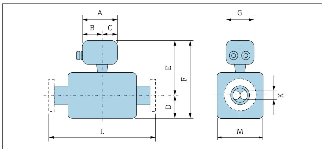
*Код заказа «Корпус», опция А «Компактное исполнение, алюминий с покрытием»*
