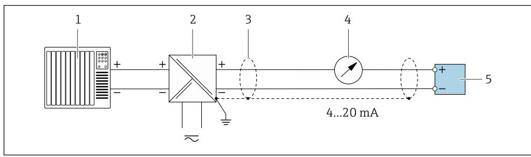
**■ 3** Пример подключения для токового выхода 4–20 mA HART (пассивного)
