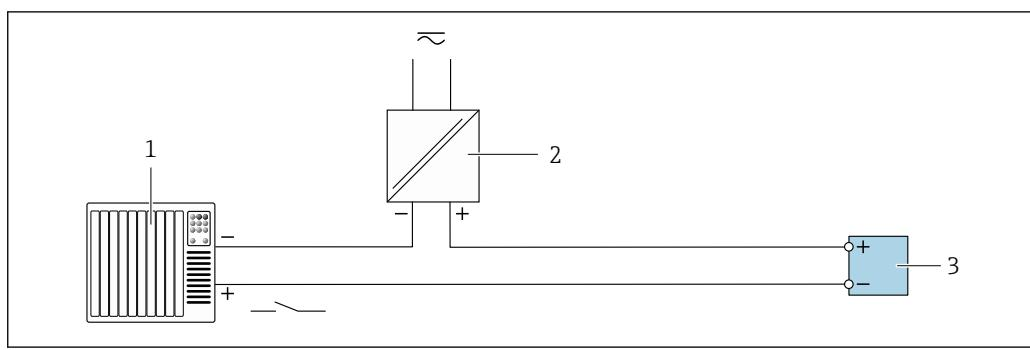
图 20 Пример подключения для входного сигнала состояния
