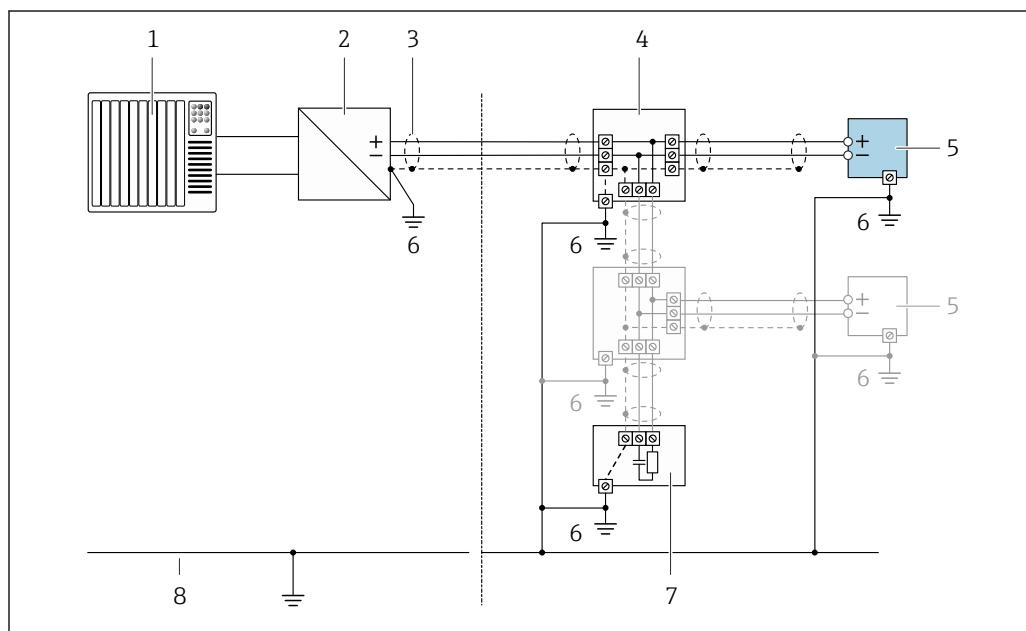
图 5 Пример подключения для PROFIBUS PA
