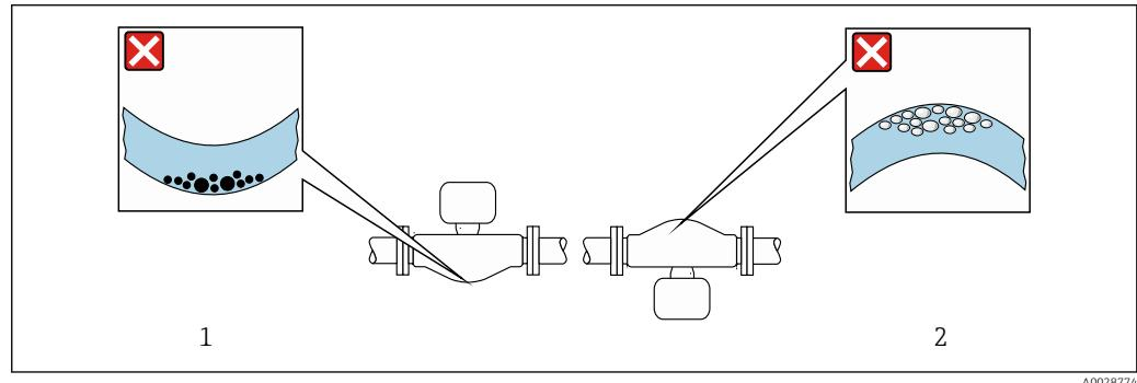
22 Монтажная позиция датчика с изогнутой измерительной трубкой
