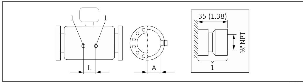
1 Соединительный ниппель для соединений для продувки: код заказа «Опции сенсора», опция CH «Соединение для продувки»
