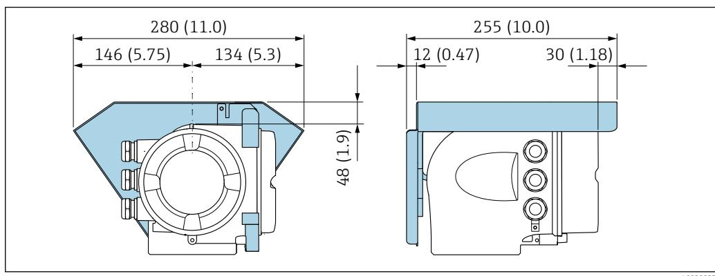
■ 41 Защитный козырек для прибора Proline 500; единицы измерения – мм (дюймы)
