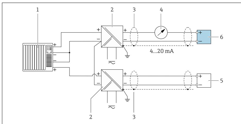
图 4 Пример подключения для входа HART с общим минусом (пассивного)
