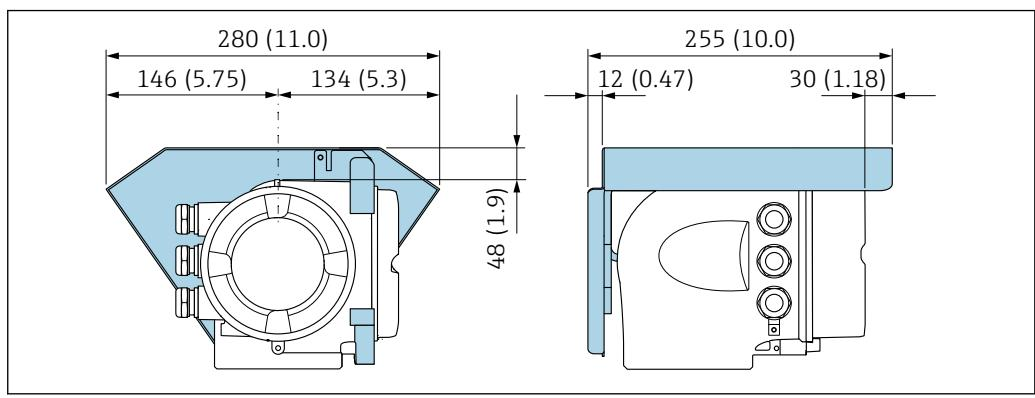
■ 28 Защитный козырек для прибора Proline 500; единицы измерения – мм (дюймы)
