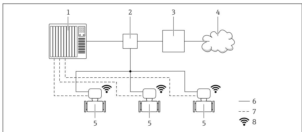
1 Система автоматизации, например, Simatic S7 (Siemens)
