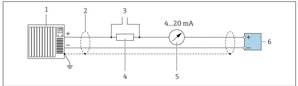
■ 2 Пример подключения токового выхода 4–20 mA HART (активного)
