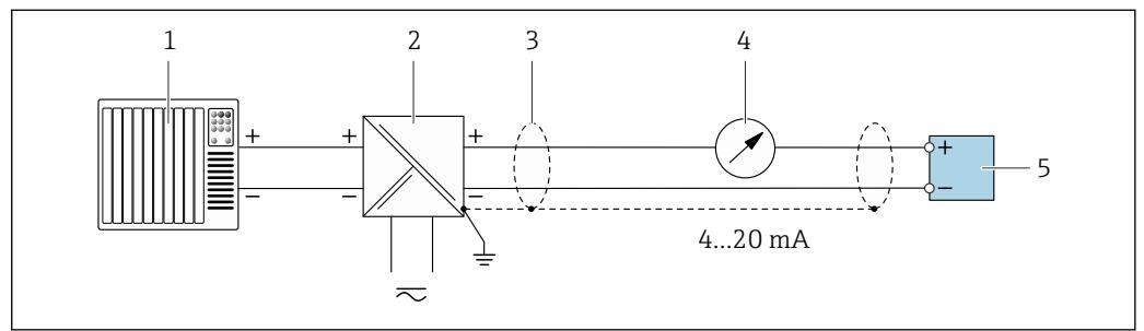
■ 3 Пример подключения для токового выхода 4–20 mA HART (пассивного)
