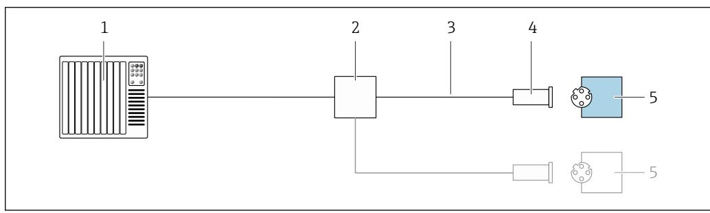
■ 7 Пример подключения для EtherNet/IP
