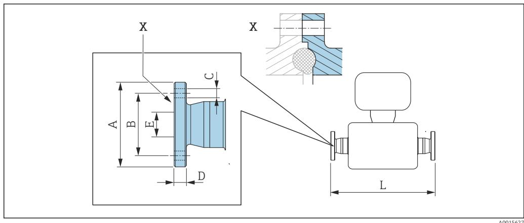
■ 38 Деталь X: асимметричное присоединение к процессу, деталь, обозначенная синим цветом, предоставляется поставщиком
