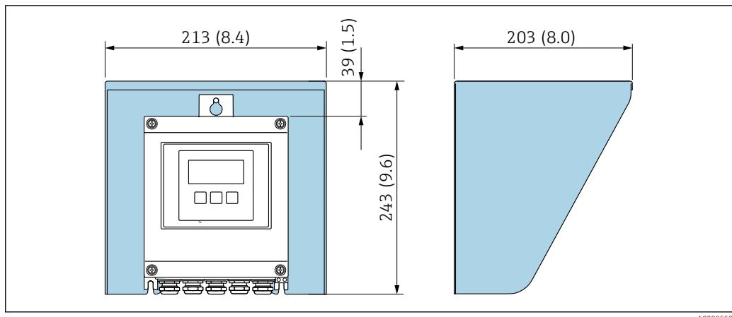
■ 40 Защитный козырек для прибора Proline 500 в цифровом исполнении; единицы измерения – мм (дюймы)
