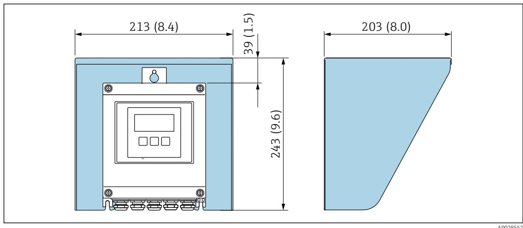
■ 27 Защитный козырек для прибора Proline 500 в цифровом исполнении; единицы измерения – мм (дюймы)
