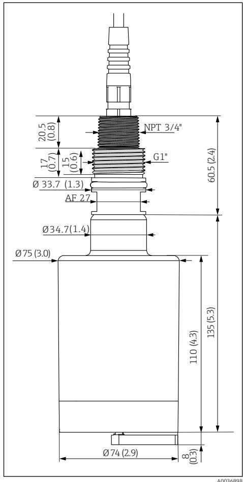
3 *Размеры датчика с грязеочистителем. Размеры в мм (дюймах)*
