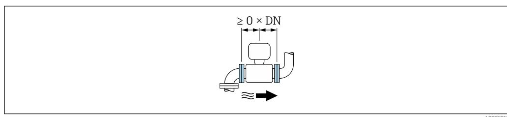
**i** Монтажные размеры: информация о размерах и монтажной длине прибора в различных вариантах установки → 45.
