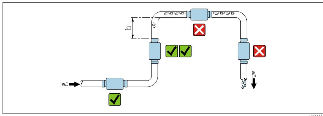
Предпочтительна установка датчика в восходящей трубе. Убедитесь, что до следующего изгиба трубы соблюдается достаточное расстояние:  $h \geq 2 \times DN$
