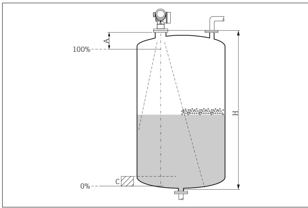
A Рупорная антенна: длина антенны + 50 мм (2 дюйм); минимум 200 мм (7,87 дюйм)
