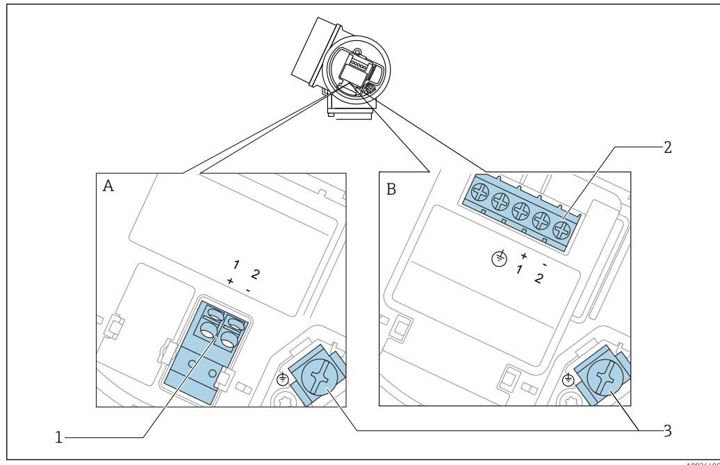
■ 2 Назначение клемм; 2-проводное подключение; 4–20 мА HART
