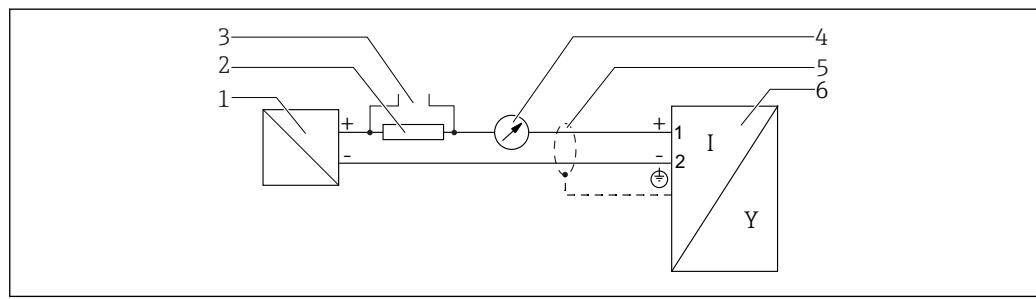
■ 3 Блок-схема 2-проводного подключения: 4–20 мА HART
