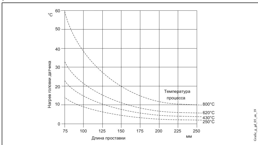
Рис. 8: Нагрев головки в зависимости от температуры процесса
