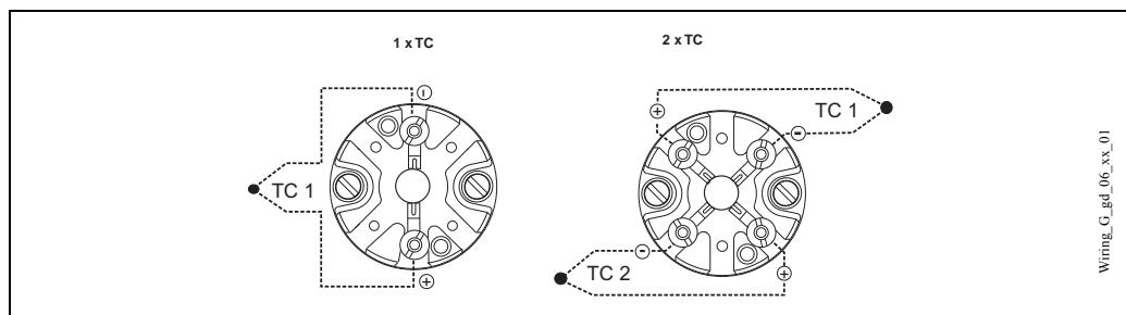
Рис. 12: Стандартная схема подключения (керамическая клеммная коробка)
