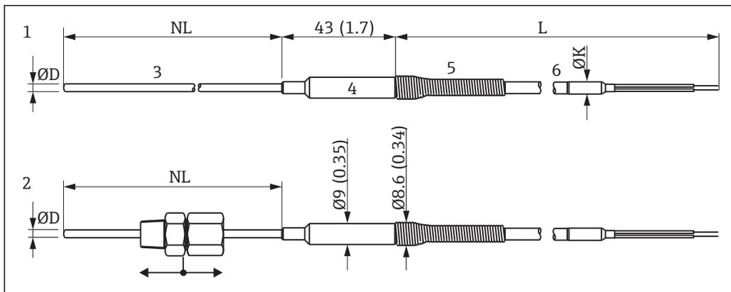
6 Конструкция термометра TSC310, размеры в мм (дюймах)
