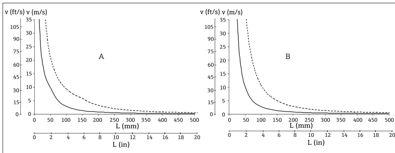
**4** Допустимая скорость потока: Ø3 мм (0,12 дюйма) (сплошная линия), Ø6 мм (0,24 дюйма) (пунктирная линия)
