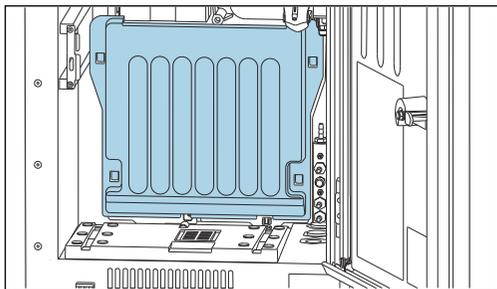
Снимите крышку, закрепленную крючками.
