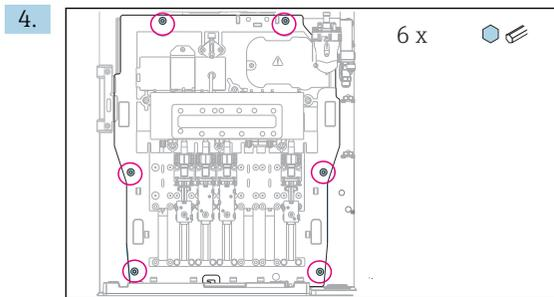
Выверните 6 винтов крепежной панели шестигранным ключом.
