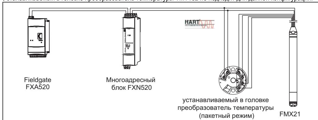
Без компенсации могут возникнуть дополнительные ошибки, которые при температуре, например, 70 °C составляют до 4 %. С использованием компенсации плотности эти ошибки можно сократить до 0,5% во всем диапазоне температур 0...70 °C (32...158 °F).
