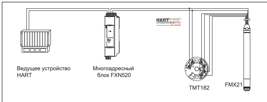
**Использование сигнала внешней температуры, передаваемого FMX21 посредством протокола HART в пакетном режиме**
