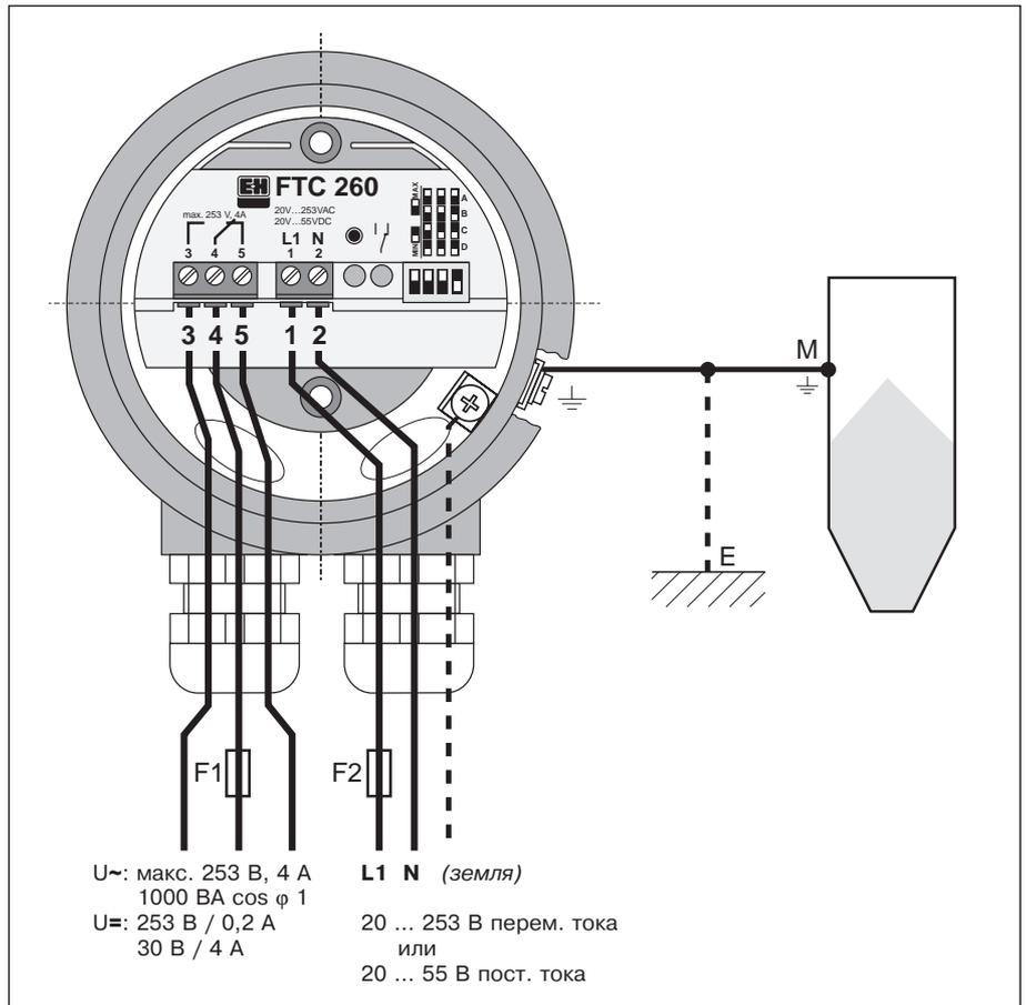
Minicap FTC 260: подключение по 3-проводной схеме постоянного напряжения с PNP-выходом.
