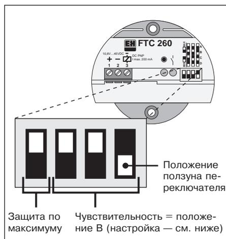
Заводские установки на DIP-переключателе
