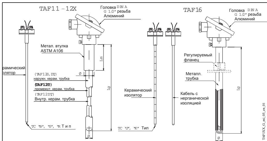
*Рис. 4: Детали чувствительного элемента*
