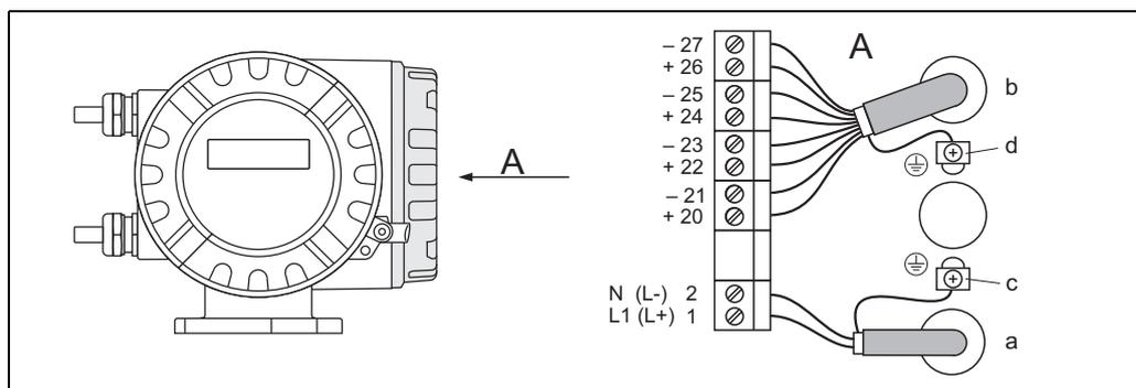
Подключение преобразователя, сечение кабеля: макс. 2.5 мм<sup>2</sup>
