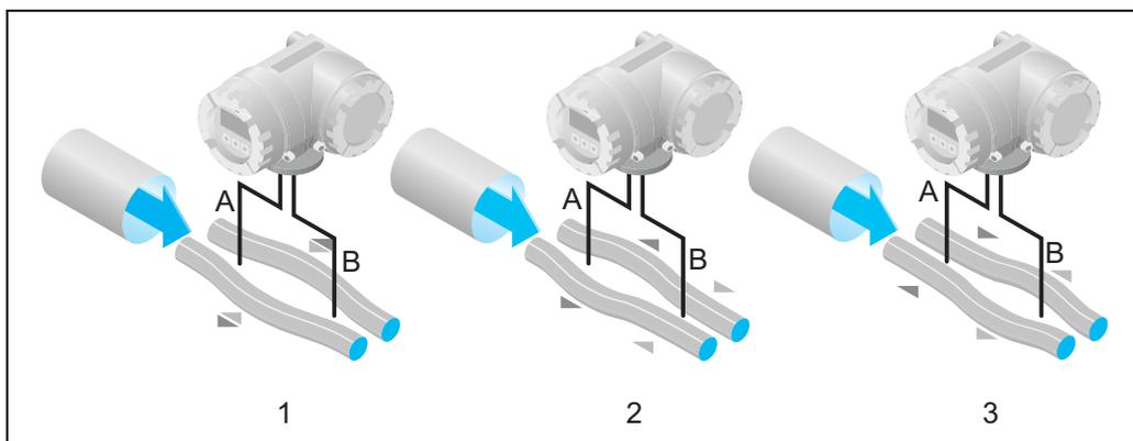
Разность фаз (A-B) увеличивается с увеличением массового расхода. Электродинамические датчики регистрируют колебания трубки на входе и выходе.
