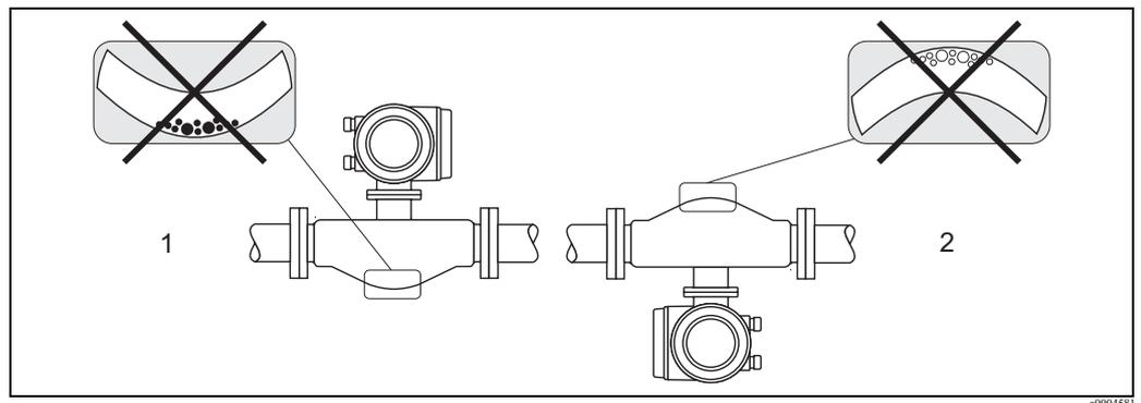
Горизонтальная установка сенсора с изогнутой измерительной трубкой
