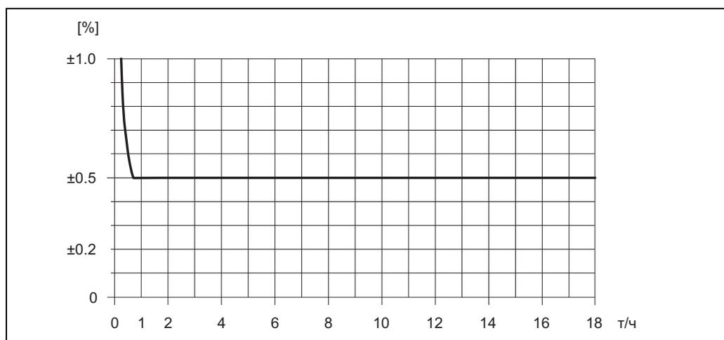
Макс. погрешность измерения в % от измеренного значения (пример: Promass 40E / ДУ 25)
