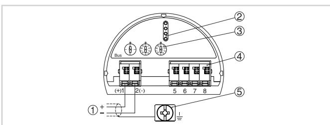
Отсек электроники и подключения (однокамерный корпус)
