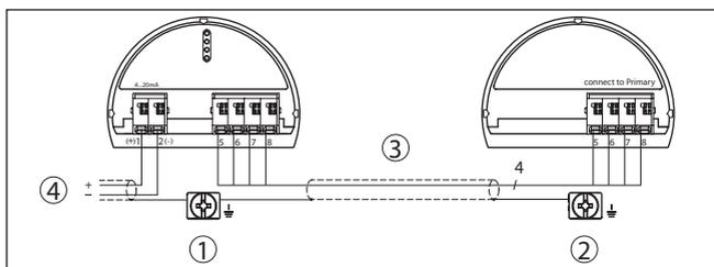
Рис. 5: Пример подключения - электронное дифференциальное давление
