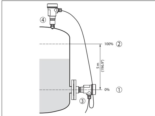
Рис. 6: Пример параметрирования: Установка Min./Max. для измерения уровня
