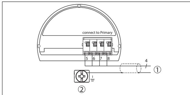
Рис. 4: Схема подключения VEGABAR 81 как ведомого устройства
