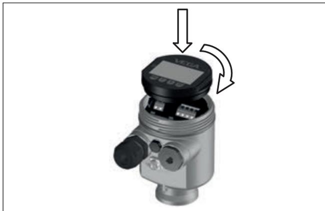
Рис. 33: Установка модуля индикации и настройки в отсеке электроники однокамерного корпуса
