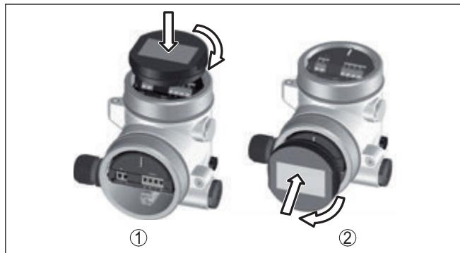
Рис. 28: Установка модуля индикации и настройки в двухкамерном корпусе
