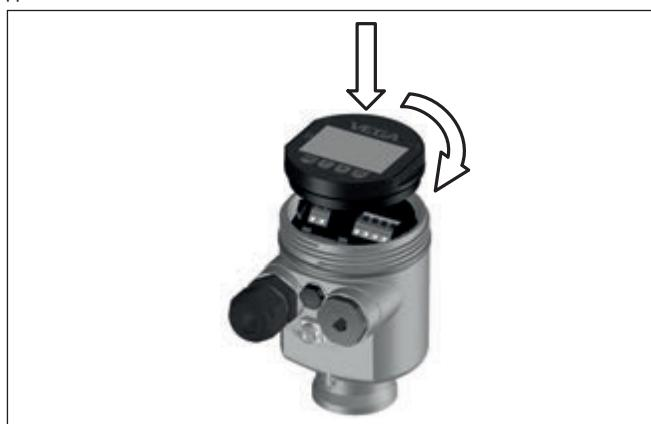
Рис. 28: Установка модуля индикации и настройки в отсеке электроники однокамерного корпуса
