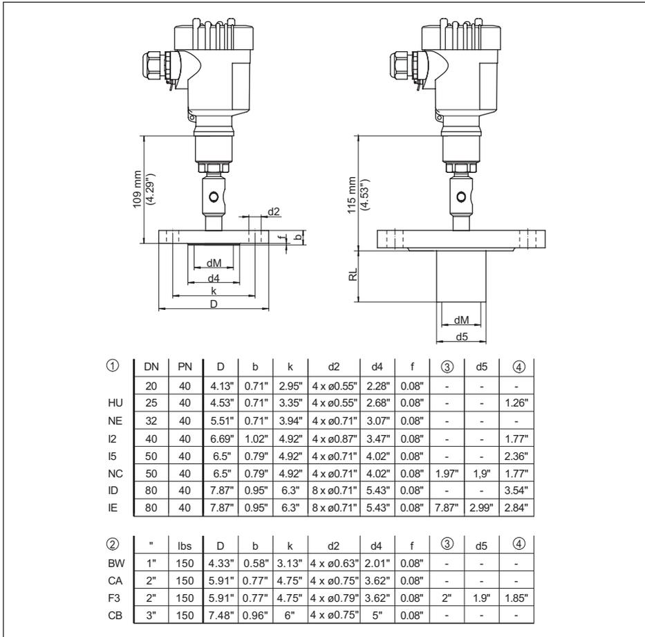
Рис. 32: VEGABAR 81 - фланцевое присоединение, размеры в дюймах
