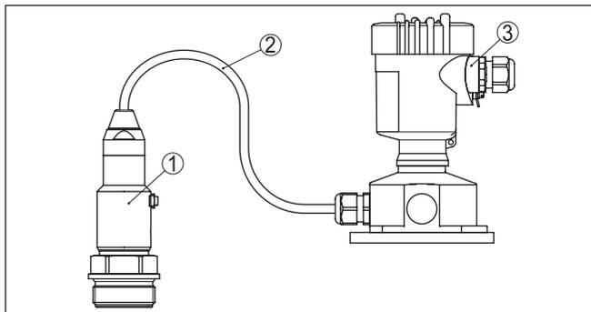
Рис. 18: VEGABAR 81 в исполнении IP68, 25 bar, с осевым выводом кабеля и выносным корпусом
