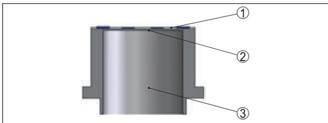
Рис. 4: Конструкция измерительной системы с тензометрическим чувствительным элементом
