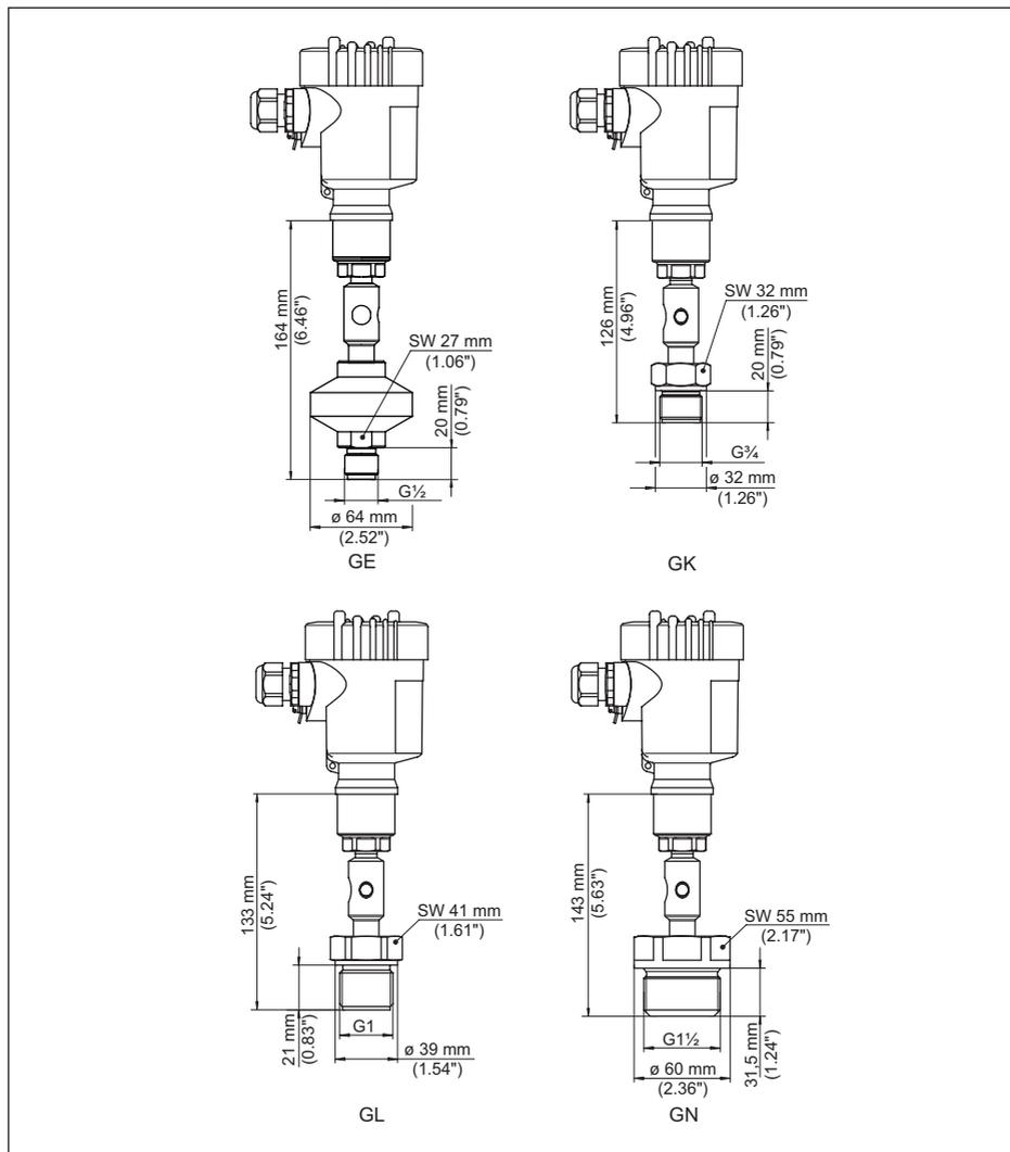
Рис. 29: VEGABAR 81, резьбовое присоединение
