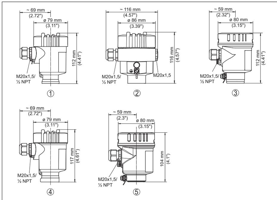
Рис. 27: Корпуса в исполнении IP66/IP67 и IP66/IP68 (0,2 bar), (с установленным модулем индикации и настройки корпус выше на 9 мм/0.35 in или 18 мм/0.71 in)
