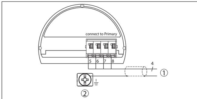
Рис. 17: Схема подключения VEGABAR 81 как ведомого устройства
