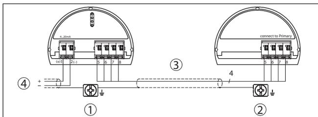
Рис. 22: Пример подключения - электронное дифференциальное давление
