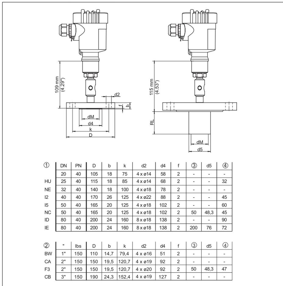
Рис. 31: VEGABAR 81 - фланцевое присоединение, размеры в мм
