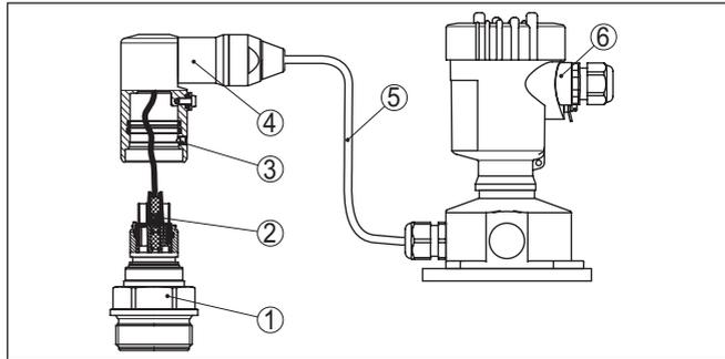
Рис. 24: VEGABAR 81 в исполнении IP68, 25 bar, с боковым выводом кабеля и выносным корпусом
