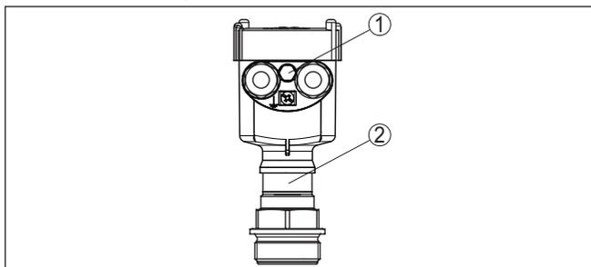
Рис. 8: Положение фильтрующего элемента - газонепроницаемая втулка
