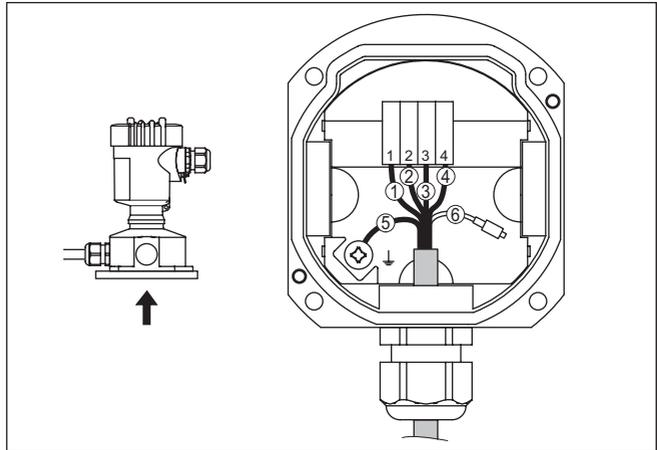
Рис. 20: Подключение рабочего узла в цоколе корпуса
