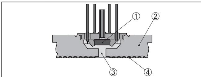
Рис. 3: Конструкция измерительной системы с пьезорезистивным чувствительным элементом
