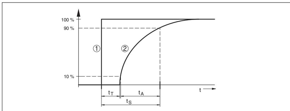
Рис. 25: Скачкообразное изменение параметров процесса.  $t_T$ : время нечувствительности;  $t_A$ : время нарастания;  $t_S$ : время реакции на скачкообразное изменение
