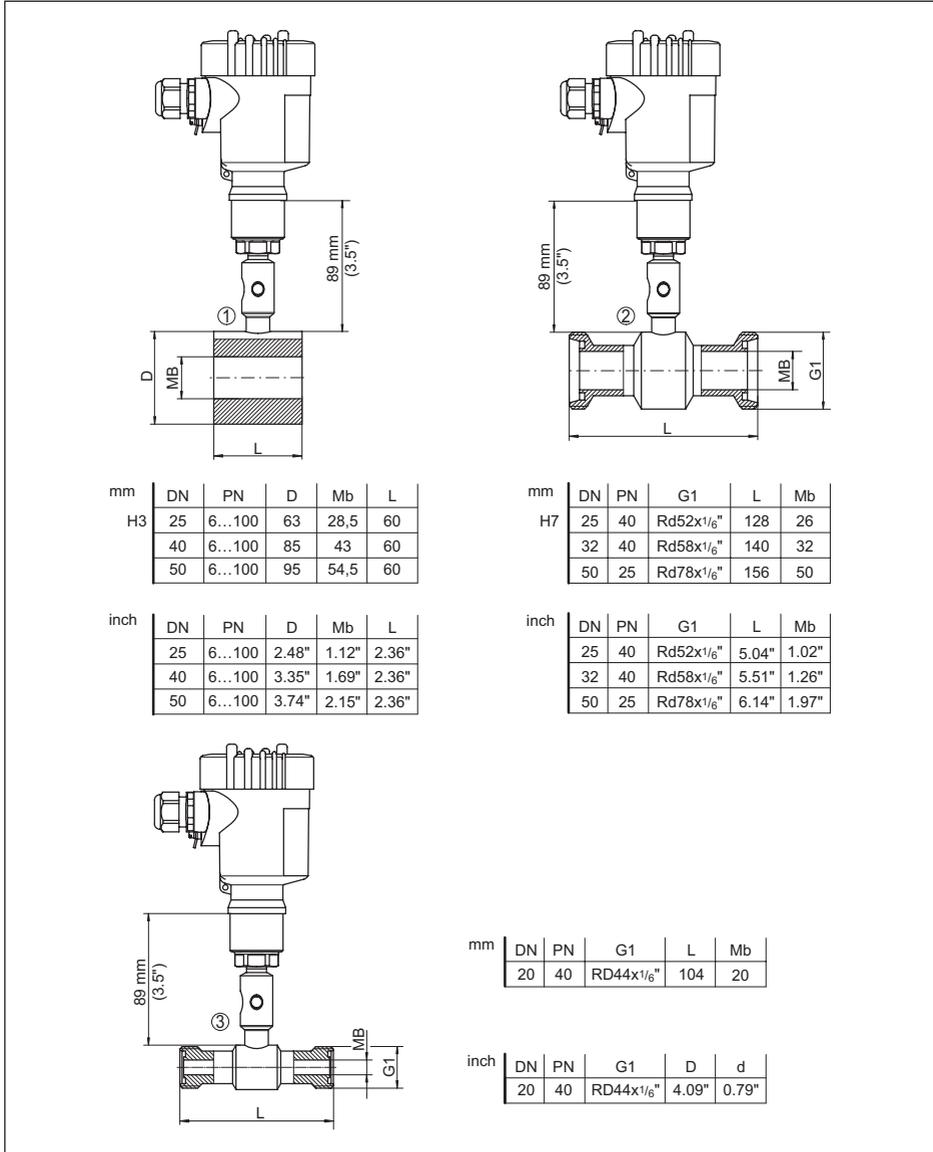
Рис. 30: VEGABAR 81 с трубчатой изолирующей диафрагмой
