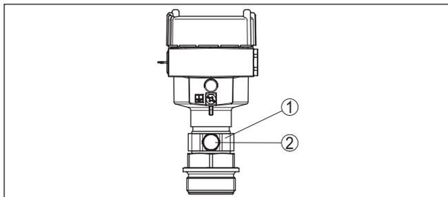
Рис. 7: Положение фильтрующего элемента - исполнение Ex d
