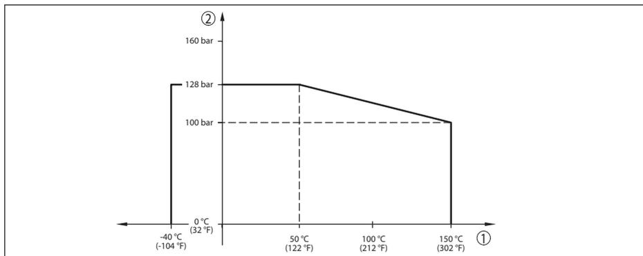
Рис. 26: Ухудшение номиналов от температуры VEGABAR 81, соединения из сплава 400 (2.4360)
