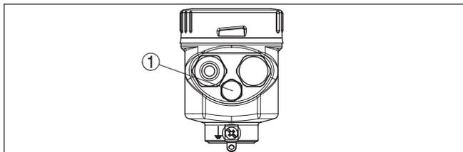
Рис. 9: Положение фильтрующего элемента - исполнение IP69K
