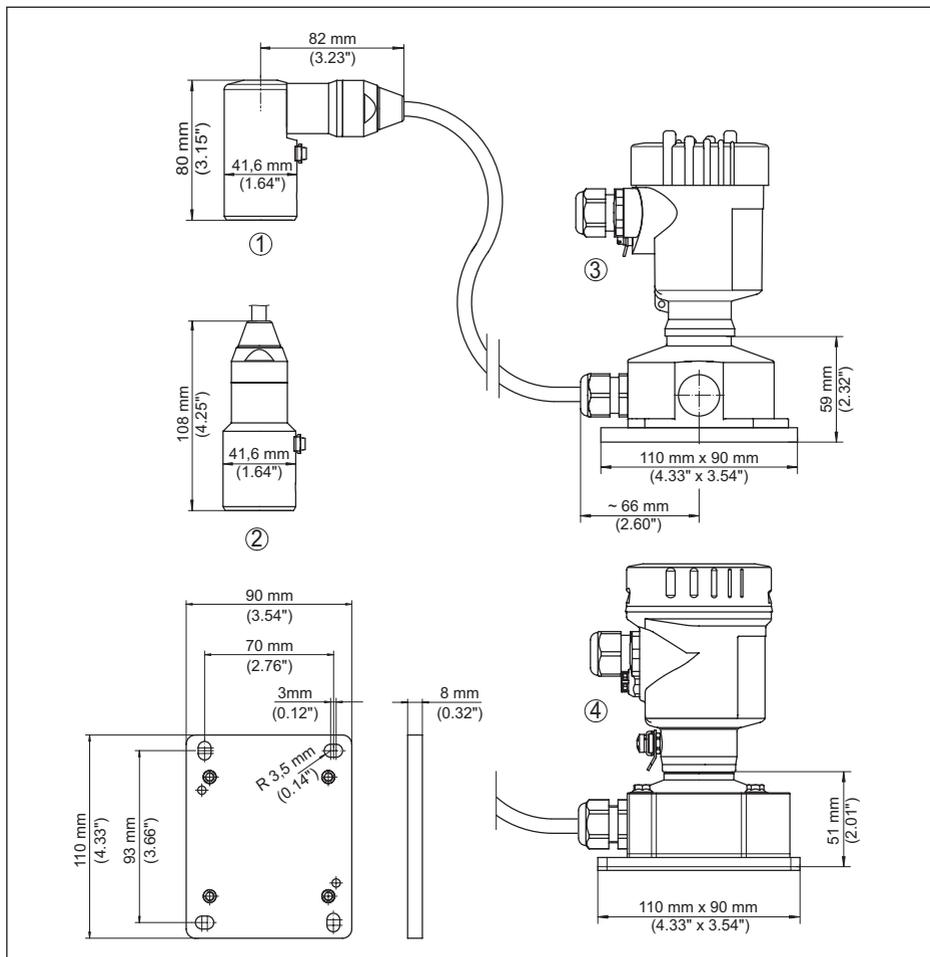
Рис. 28: VEGABAR 81, исполнение IP68 с выносным корпусом
