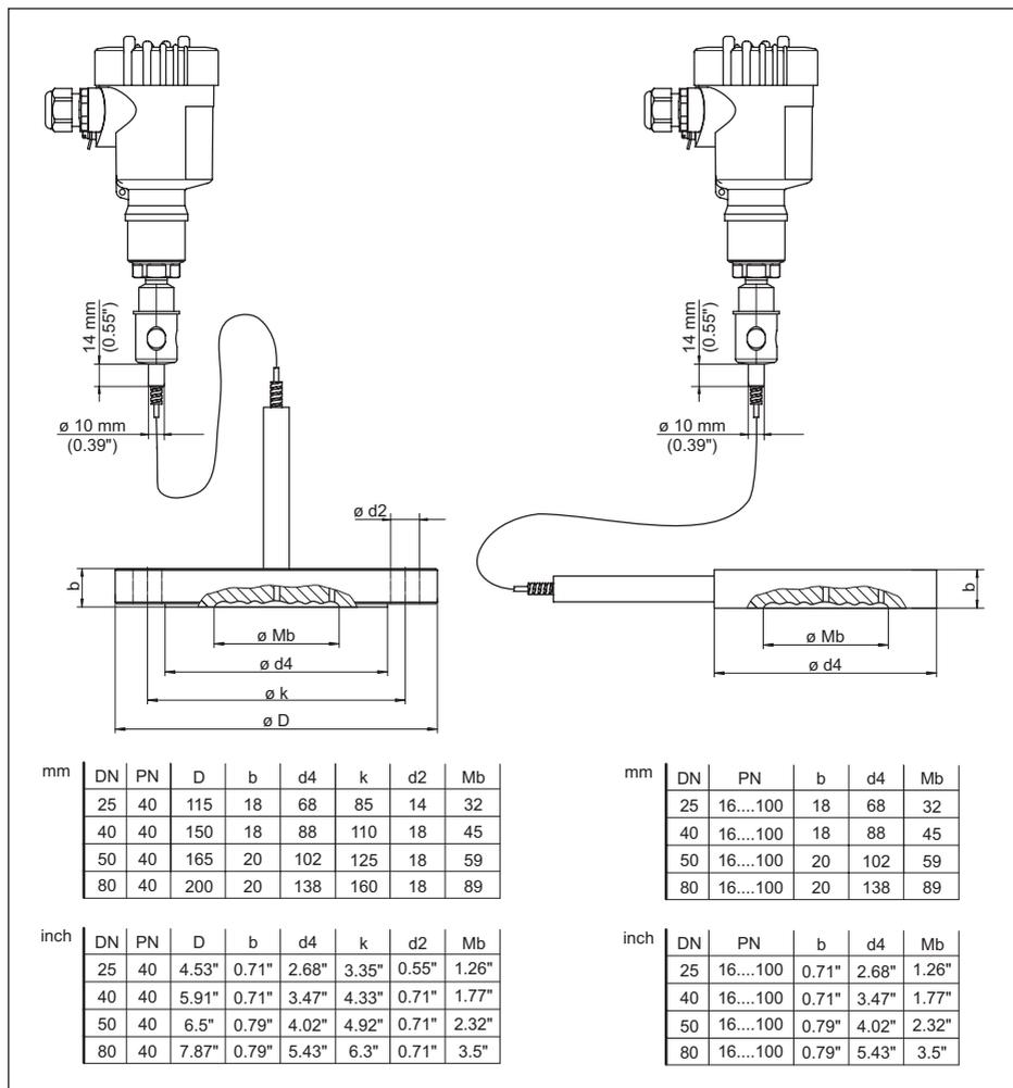
Рис. 33: VEGABAR 81, фланцевые изолирующие диафрагмы и диафрагмы-ячейки с капиллярной линией
