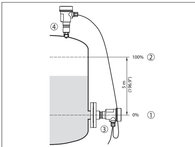
Рис. 23: Пример параметрирования: Установка Min./Max. для измерения уровня
