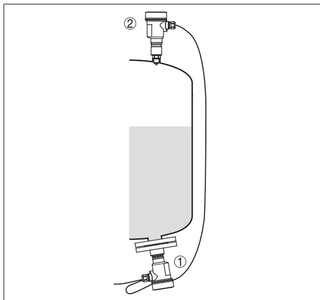
Рис. 10: Схема для измерения уровня в емкости под давлением
