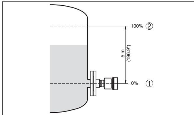
Рис. 7: Пример параметрирования: Установка Min./Max. для измерения уровня
