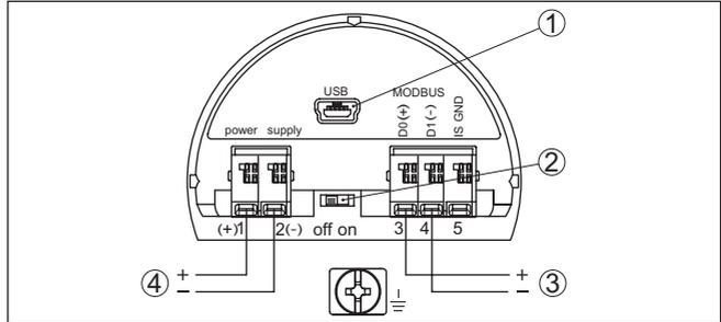
Рис. 5: Отсек подключения
