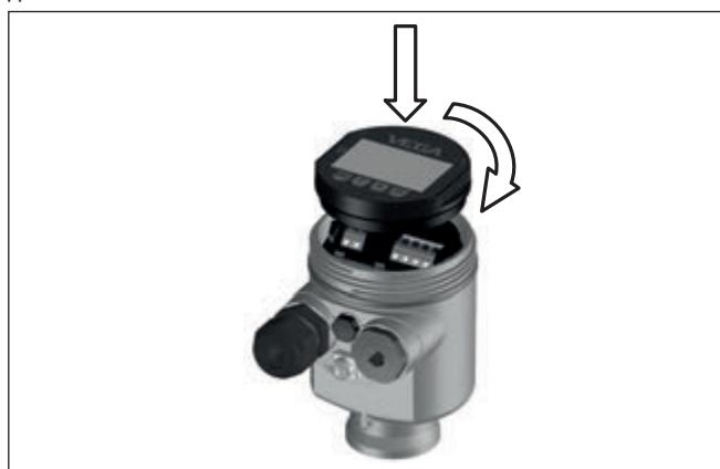
Рис. 32: Установка модуля индикации и настройки в отсеке электроники однокамерного корпуса
