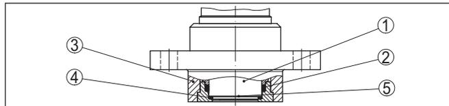
Рис. 8: Встройка измерительной ячейки заподлицо, с двойным уплотнением (пример: фланцевое присоединение с тубусом)
