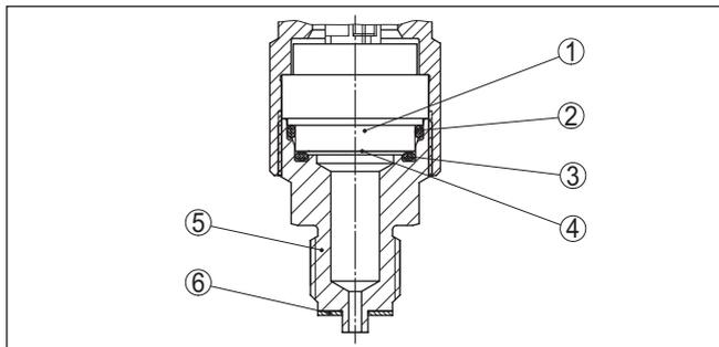
Рис. 5: Утопленная встройка измерительной ячейки (пример: манометрическое присоединение G $\frac{1}{2}$ )
