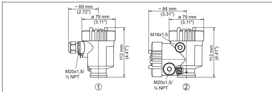
Рис. 51: Корпуса в исполнении IP66/IP67 (с установленным модулем индикации и настройки корпус выше на 9 мм/0.35 in)
