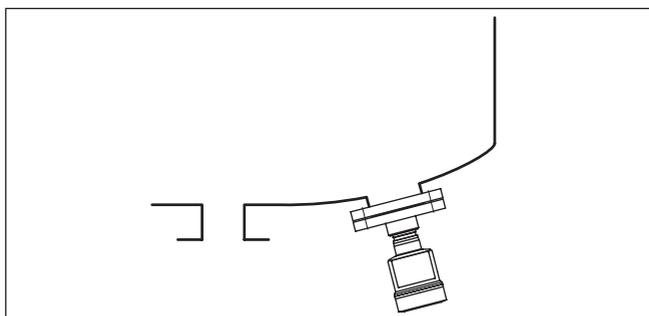
Рис. 19: Измерительная схема для измерения уровня
