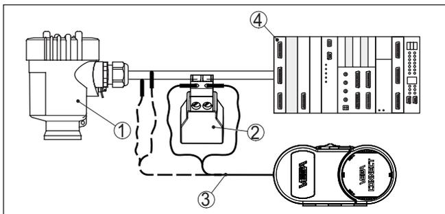
Рис. 40: Подключение ПК к сигнальному кабелю через HART
