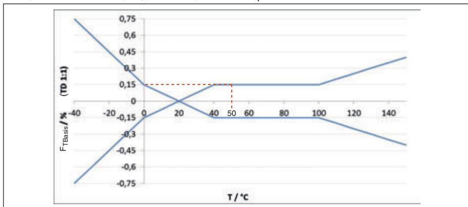
Рис. 50: Определение базовой температурной погрешности для примера выше:  $F_{T\text{Basis}} = 0,15 \%$
