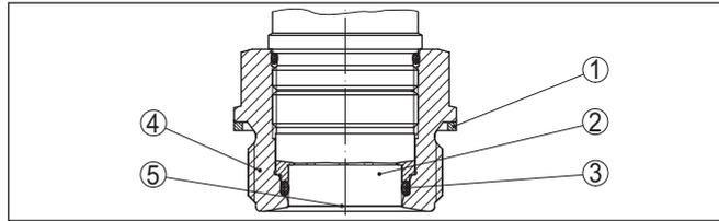
Рис. 6: Встройка измерительной ячейки заподлицо (пример: резьба G1½)
