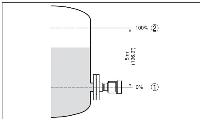
Рис. 38: Пример параметрирования: Установка Min./Max. для измерения уровня
