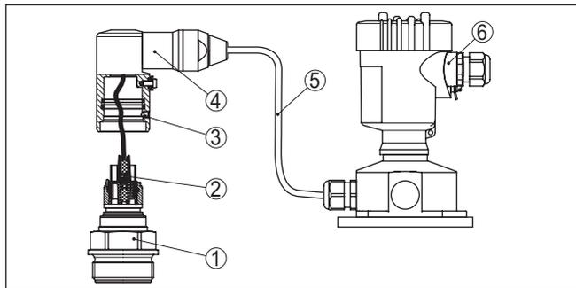
Рис. 44: VEGABAR 82 в исполнении IP68, 25 bar, с боковым выводом кабеля и выносным корпусом
