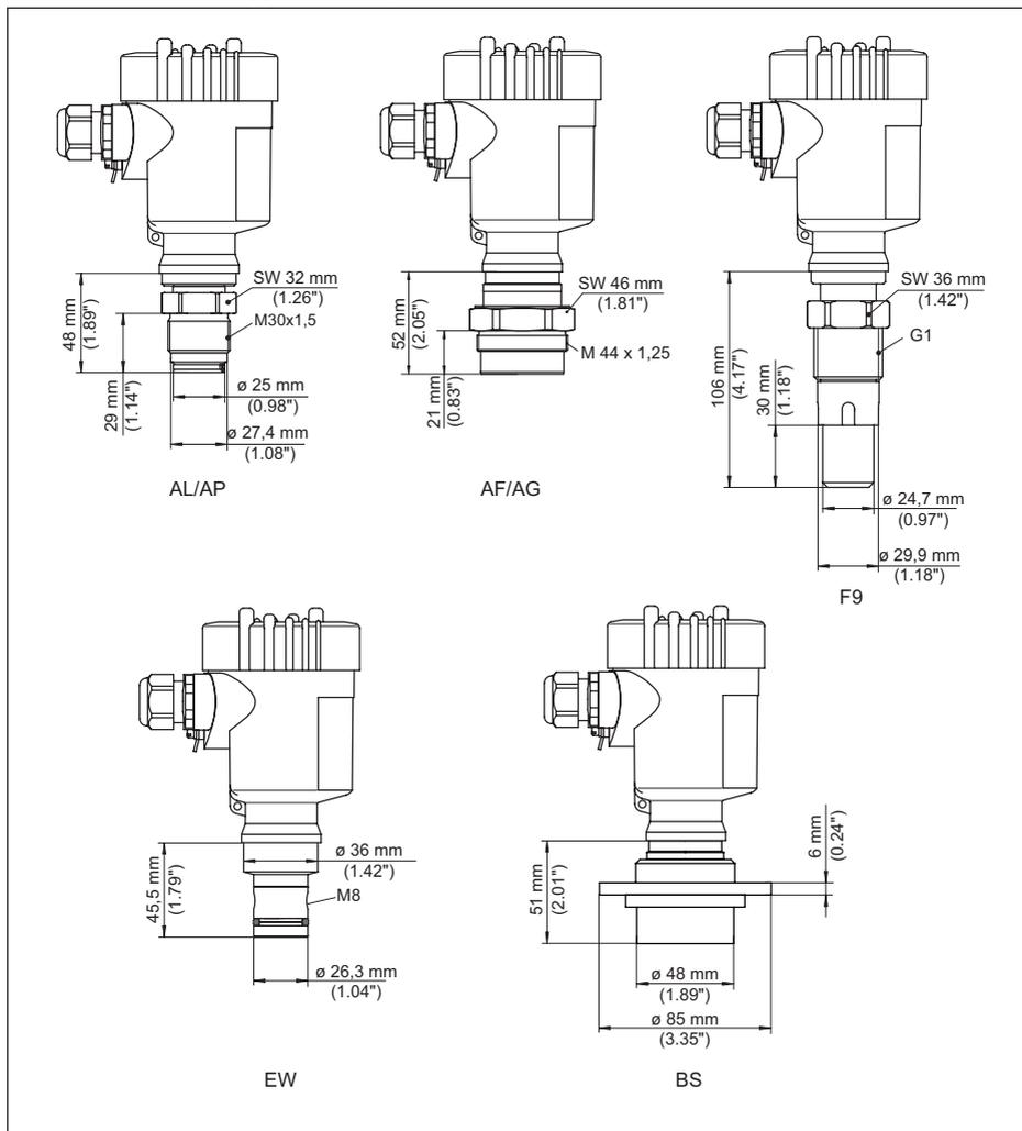
Рис. 62: VEGABAR 82, присоединение с тубусом
