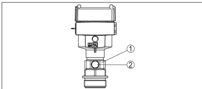
Рис. 13: Положение фильтрующего элемента - исполнение Ex d
