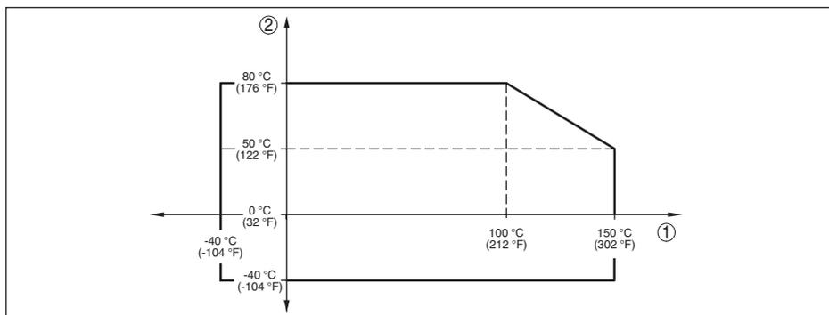
Рис. 49: Температурное снижение параметров VEGABAR 82, исполнение до +150 °C (+302 °F)
