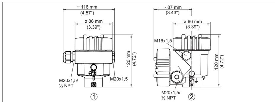
Рис. 52: Корпуса в исполнении IP66/IP68 (0,2 bar), (с установленным модулем индикации и настройки корпус выше на 18 мм/0.71 in)
