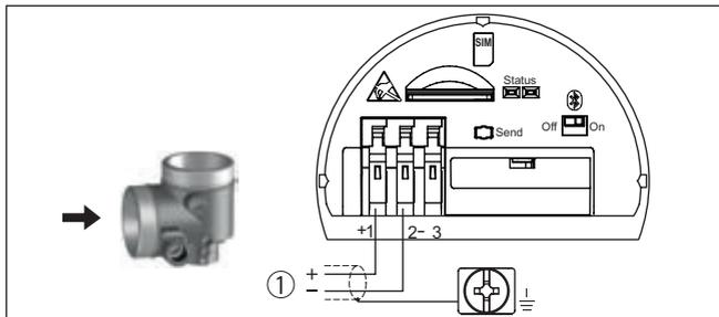
Рис. 25: Отсек подключения - модуль PLICSMOBILE 81
