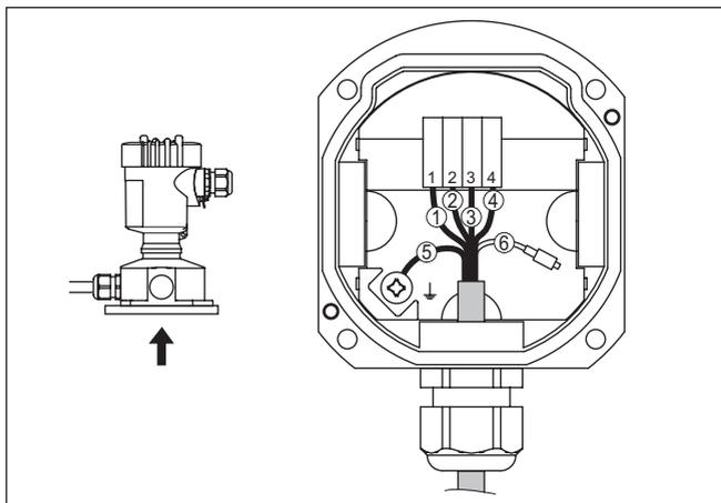
Рис. 31: Подключение рабочего узла в цоколе корпуса
