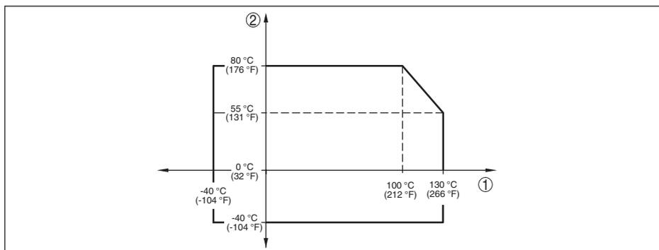
Рис. 48: Температурное снижение параметров VEGABAR 82, исполнение до +130 °C (+266 °F)
