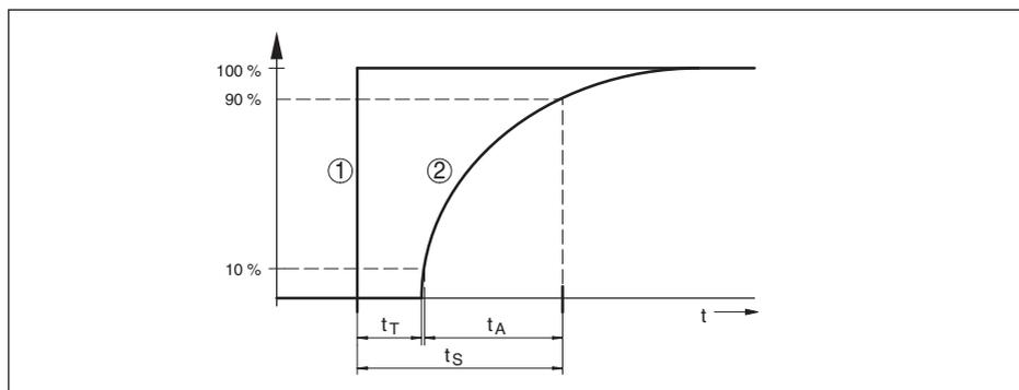
Рис. 45: Состояние при скачкообразном изменении контролируемого параметра процесса.  $t_T$ : время нечувствительности;  $t_A$ : время нарастания;  $t_S$ : время реакции на скачкообразное изменение
