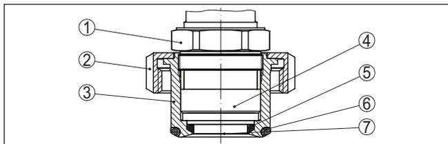
Рис. 42: VEGABAR 82, конструкция асептического присоединения с шлицевой накидной гайкой
