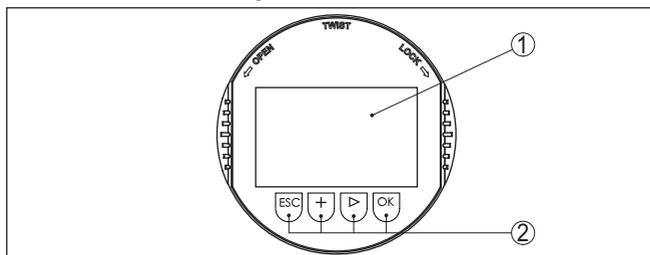
Рис. 36: Элементы индикации и настройки
