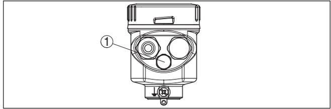
Рис. 15: Положение фильтрующего элемента - исполнение IP69K
