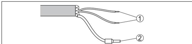
Рис. 30: Назначение проводов постоянно подключенного соединительного кабеля
