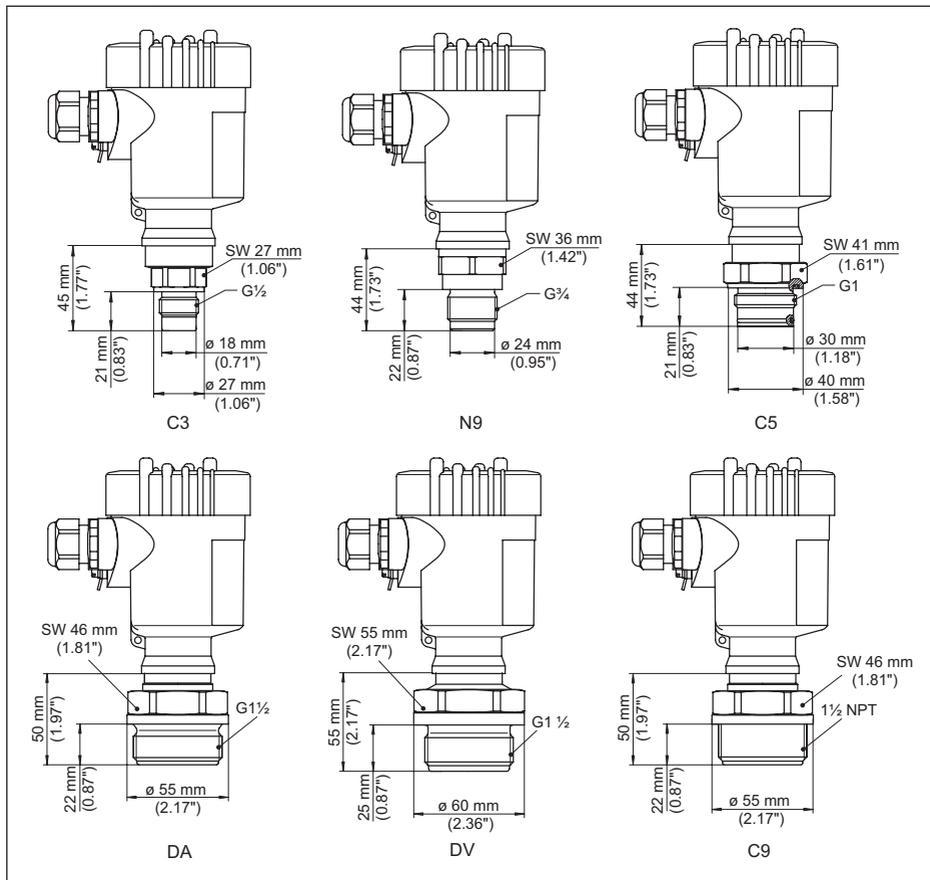
Рис. 59: VEGABAR 82, резьбовое присоединение, заподлицо
