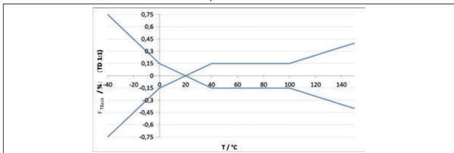
Рис. 46: Базовая температурная погрешность  $F_{T_{Basis}}$  при TD 1 : 1
