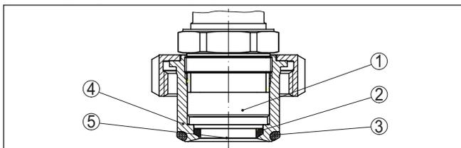
Рис. 9: Гигиеническая встройка измерительной ячейки (пример: асептическое присоединение с шлицевой накидной гайкой)
