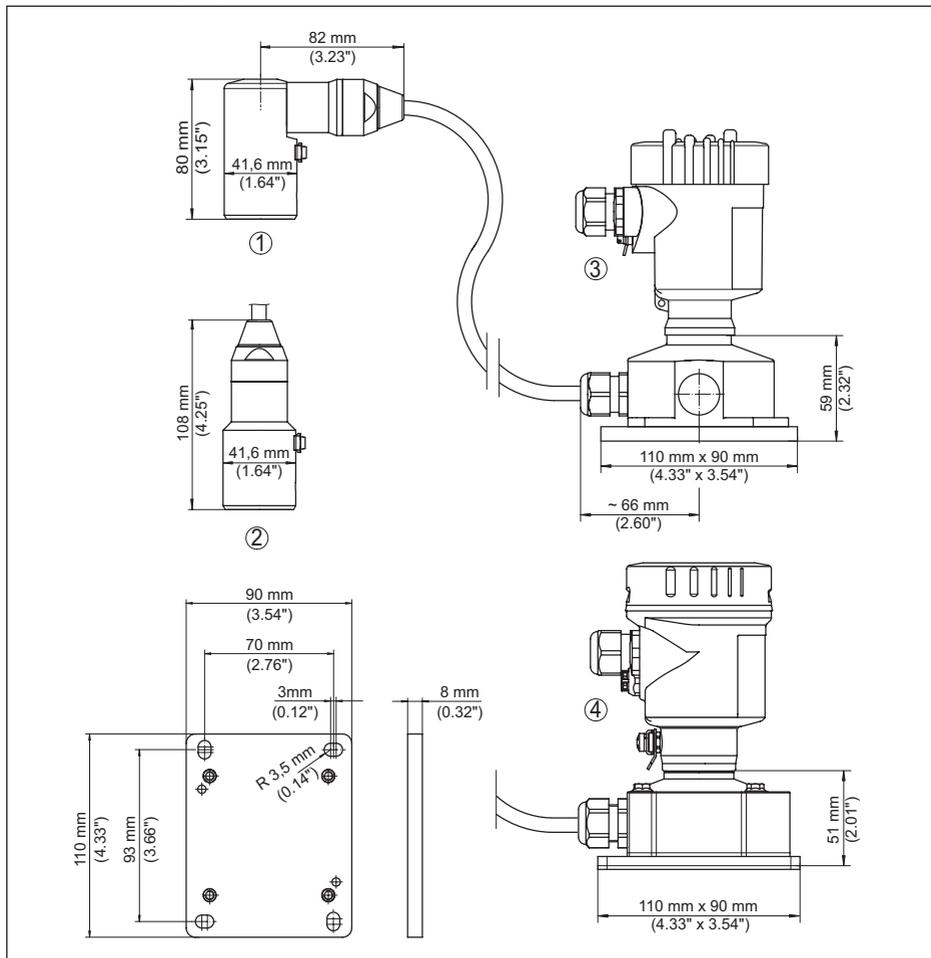
Рис. 57: VEGABAR 82, исполнение IP68 с выносным корпусом
