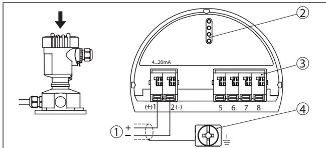
Рис. 32: Отсек электроники и подключения в выносном корпусе
