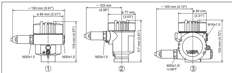
Рис. 55: Корпуса в исполнении IP66/IP68 (1 bar), (с установленным модулем индикации и настройки корпус выше на 9 мм/0.35 in или 18 мм/0.71 in)
