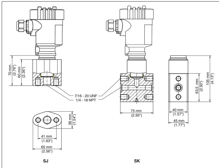
Рис. 64: VEGABAR 82, соединение по IEC 61518
