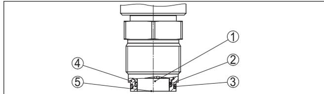
Рис. 7: Встройка измерительной ячейки заподлицо (пример: M30 x 1,5)
