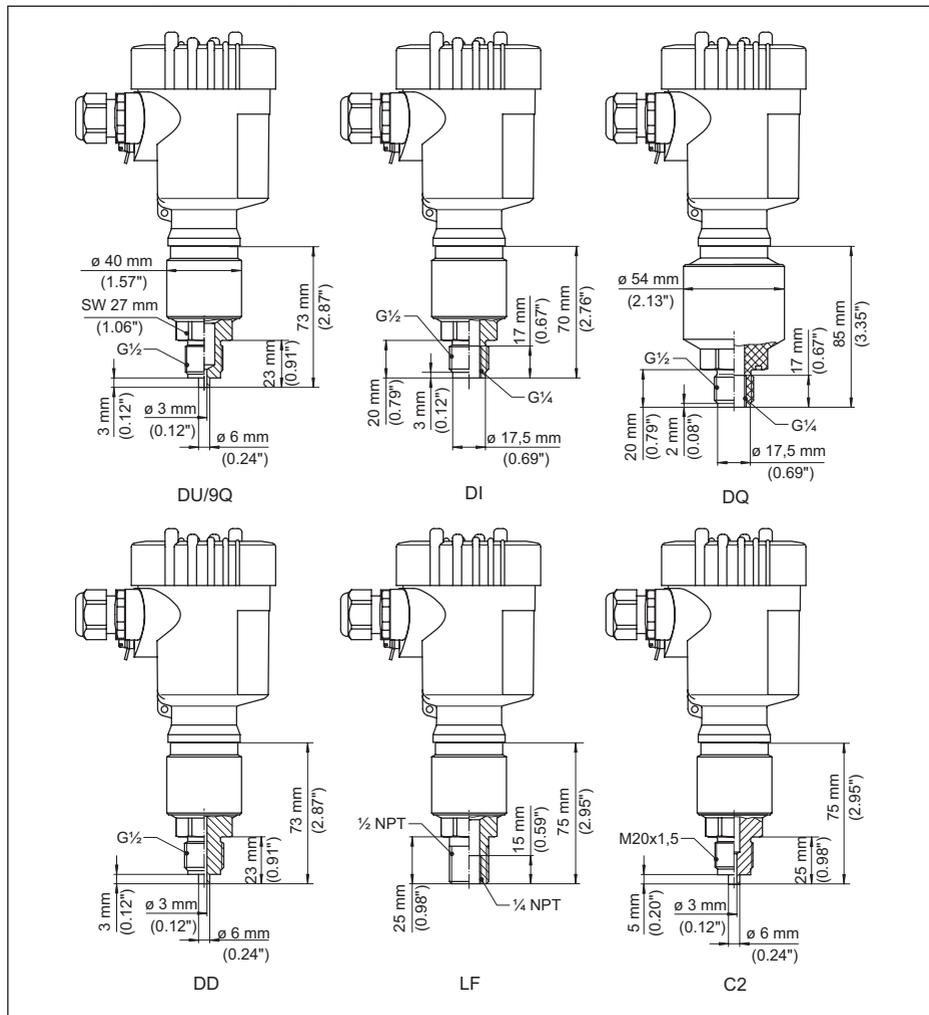
Рис. 58: VEGABAR 82, резьбовое присоединение, не заподлицо
