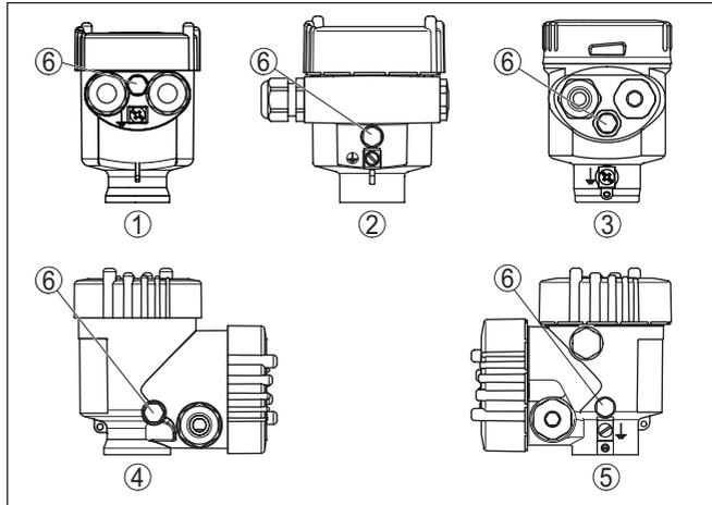
Рис. 12: Позиция фильтрующего элемента
