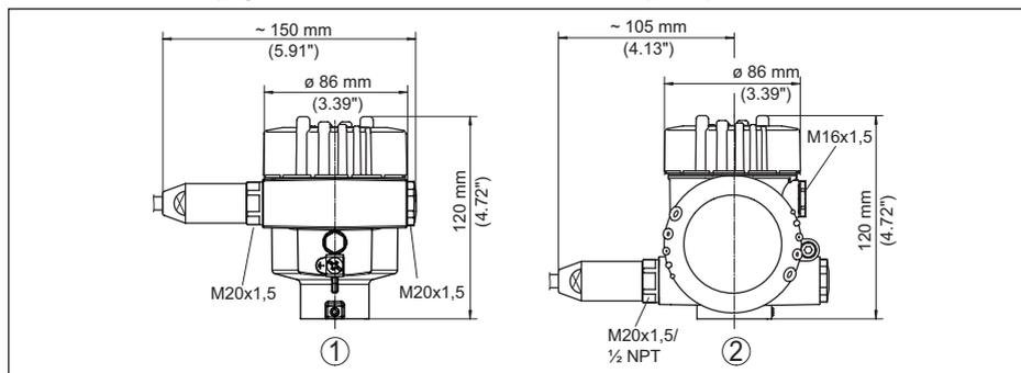
Рис. 53: Корпуса в исполнении IP66/IP68 (1 bar), (с установленным модулем индикации и настройки корпус выше на 18 мм/0.71 in)
