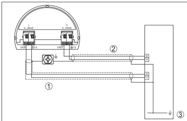
Рис. 33: Пример подключения VEGABAR 82 с дополнительным токовым выходом
