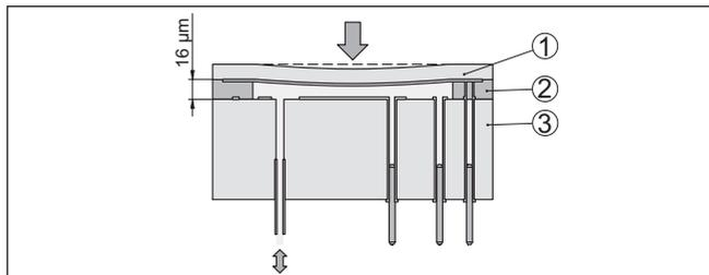
Рис. 4: Конструкция измерительной ячейки CERTEC®
