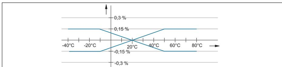
Рис. 47: Термическое изменение токового выхода
