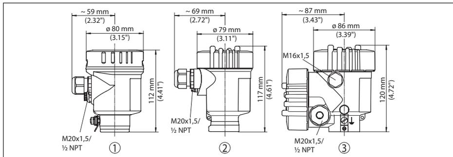
Рис. 54: Корпуса в исполнении IP66/IP68 (0,2 bar), (с установленным модулем индикации и настройки корпус выше на 9 мм/0.35 in или 18 мм/0.71 in)
