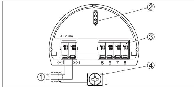
Рис. 21: Отсек электроники и подключения (однокамерный корпус)
