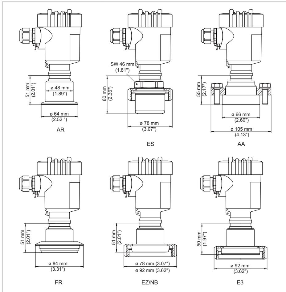
Рис. 60: VEGABAR 82, гигиеническое присоединение
