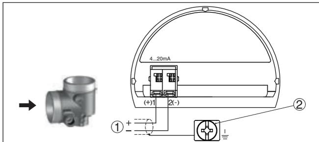
Рис. 27: Отсек подключения (двухкамерный корпус, исполнение с комбинированной взрывозащитой Ex d ia)
