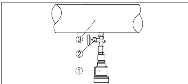
Рис. 18: Измерительная схема для измерения давления жидкостей в трубопроводах
