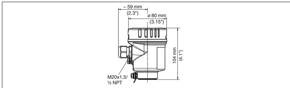
Рис. 56: Корпус в исполнении со степенью защиты IP69K (с установленным модулем индикации и настройки корпус выше на 9 мм/0.35 in)
