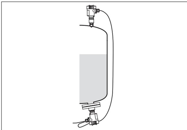
Рис. 3: Измерение дифференциального давления посредством комбинации ведущего/ведомого датчиков
