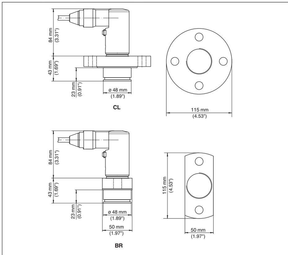
Рис. 63: VEGABAR 82, присоединение с тубусом, для слива бумажной массы
