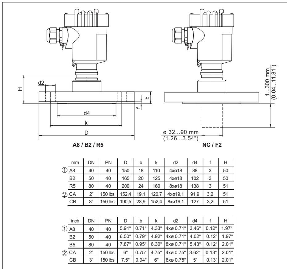
Рис. 61: VEGABAR 82 с фланцевым присоединением
