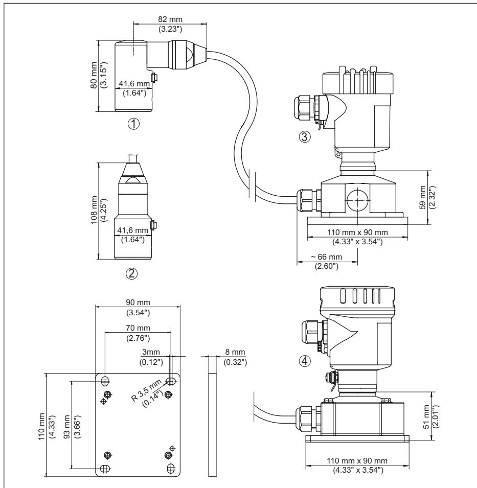
Рис. 61: VEGABAR 82, исполнение IP68 с выносным корпусом
