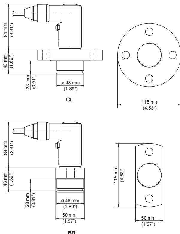
Рис. 67: VEGABAR 82, присоединение с тубусом, для слива бумажной массы
