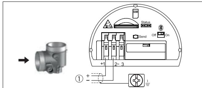
Рис. 27: Отсек подключения - модуль PLICSMOBILE 81
