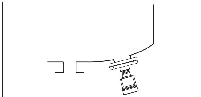
Рис. 19: Измерительная схема для измерения уровня
