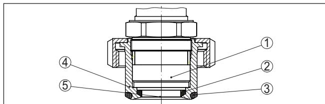
Рис. 9: Гигиеническая встройка измерительной ячейки (пример: аспептическое присоединение с шлицевой накидной гайкой)
