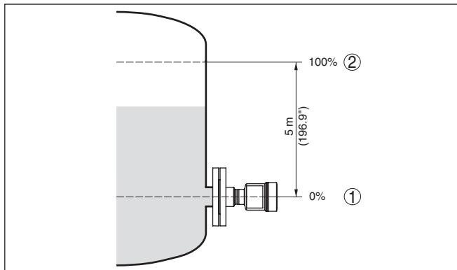
Рис. 42: Пример параметрирования: Установка Min./Max. для измерения уровня
