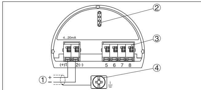
Рис. 23: Отсек электроники и подключения (однокамерный корпус)
