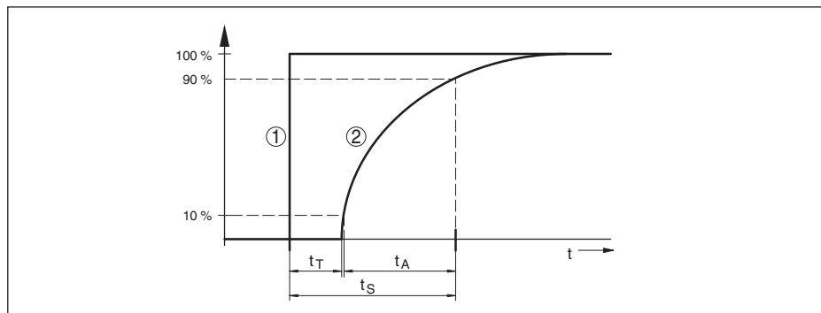
Рис. 49: Состояние при скачкообразном изменении контролируемого параметра процесса.  $t_T$ : время нечувствительности;  $t_A$ : время нарастания;  $t_S$ : время реакции на скачкообразное изменение
