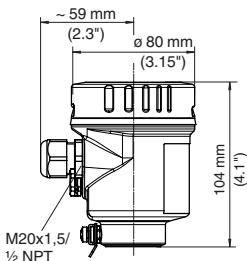
Рис. 60: Корпус в исполнении со степенью защиты IP69K (с установленным модулем индикации и настройки корпус выше на 9 мм/0.35 in)
