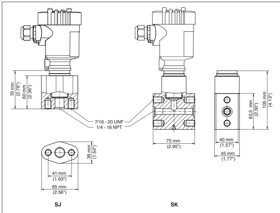
Рис. 68: VEGABAR 82, соединение по IEC 61518
