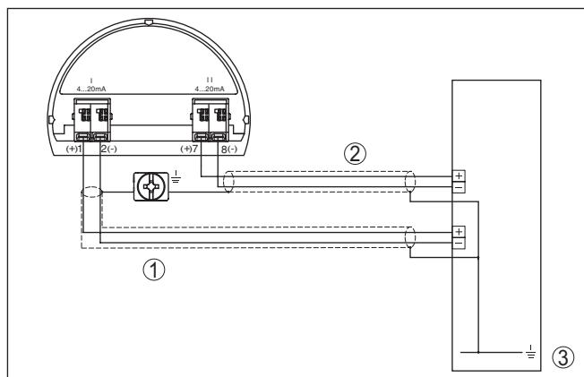
Рис. 37: Пример подключения VEGABAR 82 с дополнительным токовым выходом
