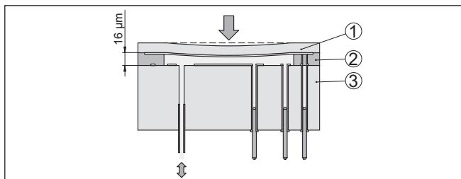
Рис. 4: Конструкция измерительной ячейки CERTEC®
