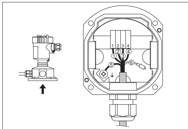
Рис. 35: Подключение рабочего узла в цоколе корпуса
