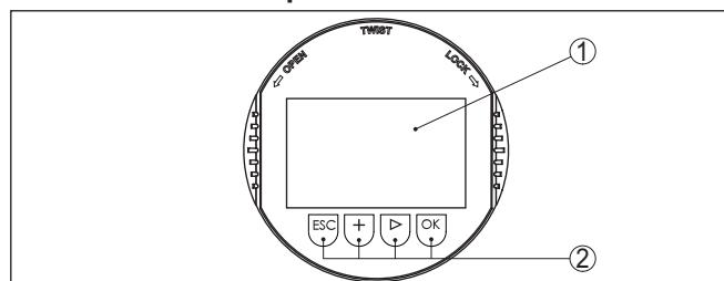
Рис. 40: Элементы индикации и настройки
