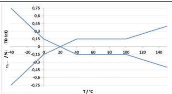
Рис. 50: Базовая температурная погрешность  $F_{T\text{Basis}}$  при TD 1 : 1
