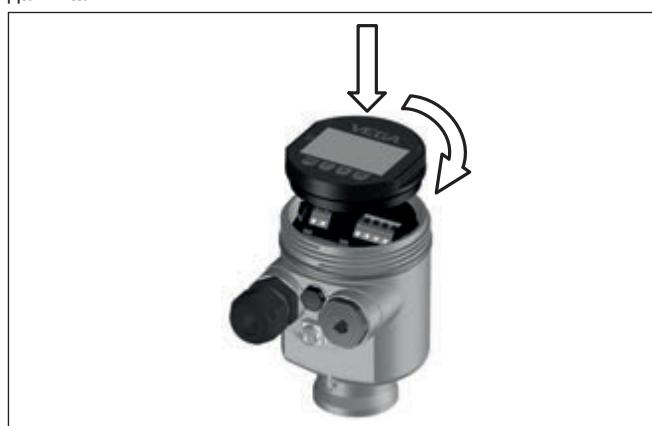
Рис. 38: Установка модуля индикации и настройки в отсеке электроники однокамерного корпуса
