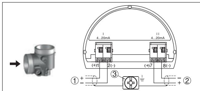
Рис. 26: Отсек подключения в двухкамерном корпусе, дополнительная электроника "Дополнительный токовый выход"
