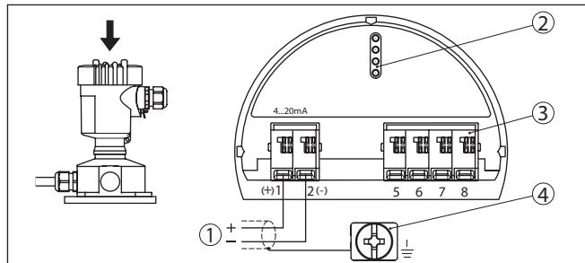
Рис. 36: Отсек электроники и подключения в выносном корпусе
