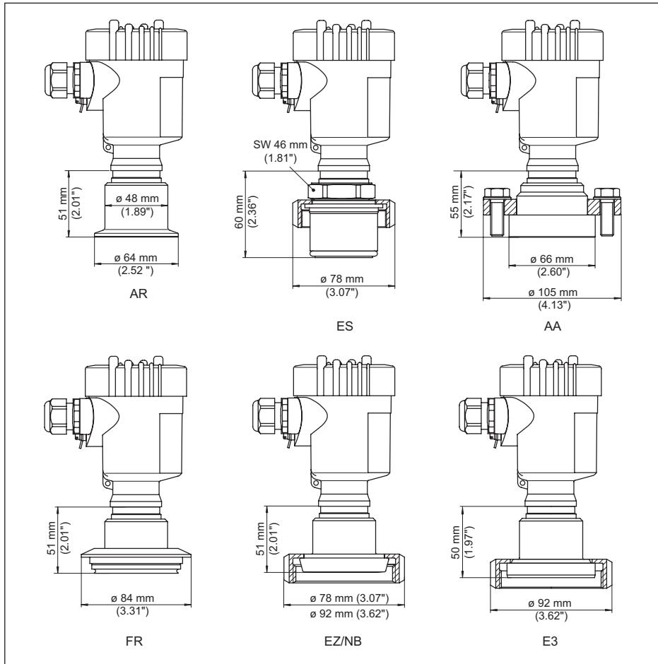
Рис. 64: VEGABAR 82, гигиеническое присоединение
