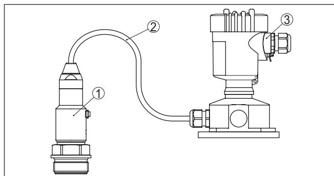
Рис. 33: VEGABAR 82 в исполнении IP68, 25 bar, с осевым выводом кабеля и выносным корпусом
