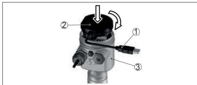
Рис. 43: Подключение ПК через интерфейсный адаптер прямо к датчику
