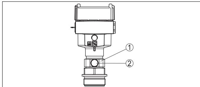
Рис. 13: Положение фильтрующего элемента - исполнение Ex d
