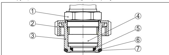
Рис. 46: VEGABAR 82, конструкция асептического присоединения с шлицевой накидной гайкой
