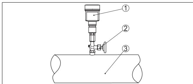
Рис. 16: Измерительная схема для измерения давления газов в трубопроводах
