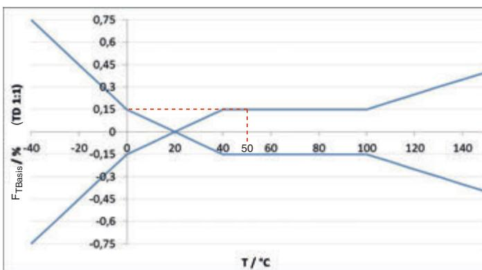
Рис. 54: Определение базовой температурной погрешности для примера выше:  $F_{\text{TBasis}} = 0,15 \%$
