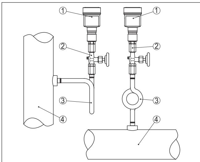
Рис. 17: Измерительная схема для измерения давления пара в трубопроводах
