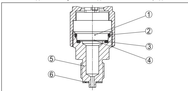
Рис. 5: Утопленная встройка измерительной ячейки (пример: манометрическое присоединение G $\frac{1}{2}$ )
