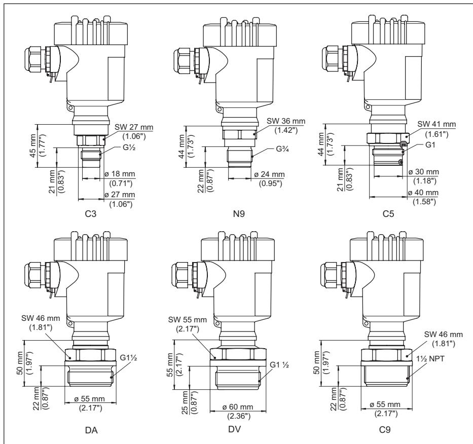
Рис. 63: VEGABAR 82, резьбовое присоединение, заподлицо
