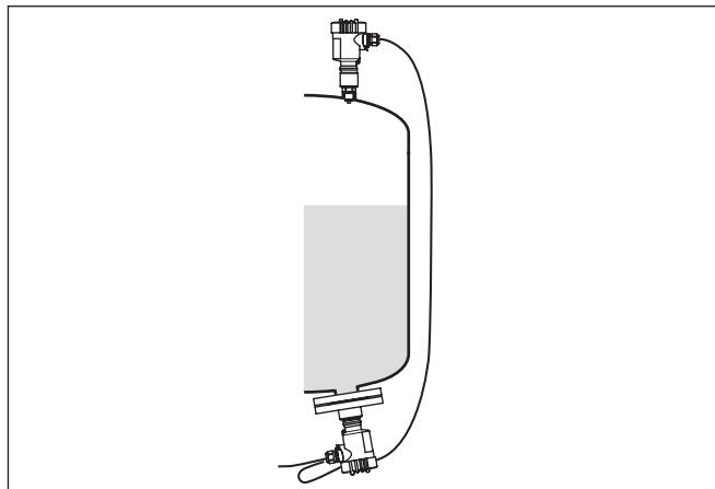
Рис. 3: Измерение дифференциального давления посредством комбинации ведущего/ведомого датчиков
