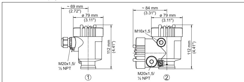
Рис. 55: Корпуса в исполнении IP66/IP67 (с установленным модулем индикации и настройки корпус выше на 9 мм/0.35 in)
