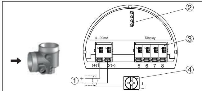
Рис. 25: Отсек подключения (двуихамерный корпус)
