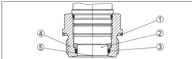
Рис. 6: Встройка измерительной ячейки заподлицо (пример: резьба G1½)
