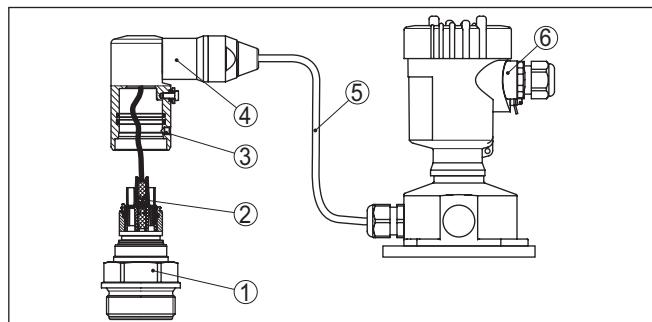
*Рис. 48: VEGABAR 82 в исполнении IP68, 25 bar, с боковым выводом кабеля и выносным корпусом*
