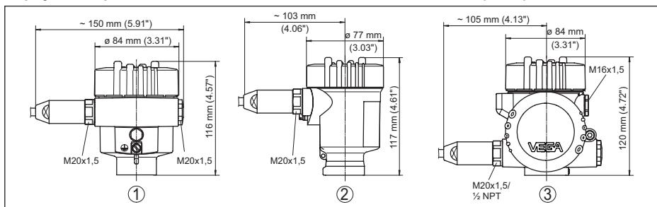
Рис. 59: Корпуса в исполнении IP66/IP68 (1 bar), (с установленным модулем индикации и настройки корпус выше на 9 mm/0.35 in или 18 mm/0.71 in)
