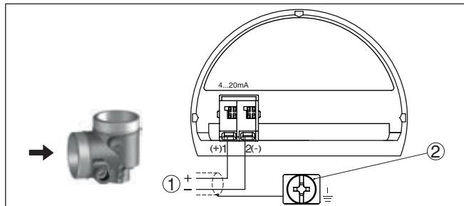
Рис. 29: Отсек подключения (двуихамерный корпус, исполнение с комбинированной взрывозащитой Ex d ia)
