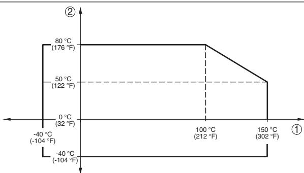
Рис. 53: Температурное снижение параметров VEGABAR 82, исполнение до +150 °C (+302 °F)
