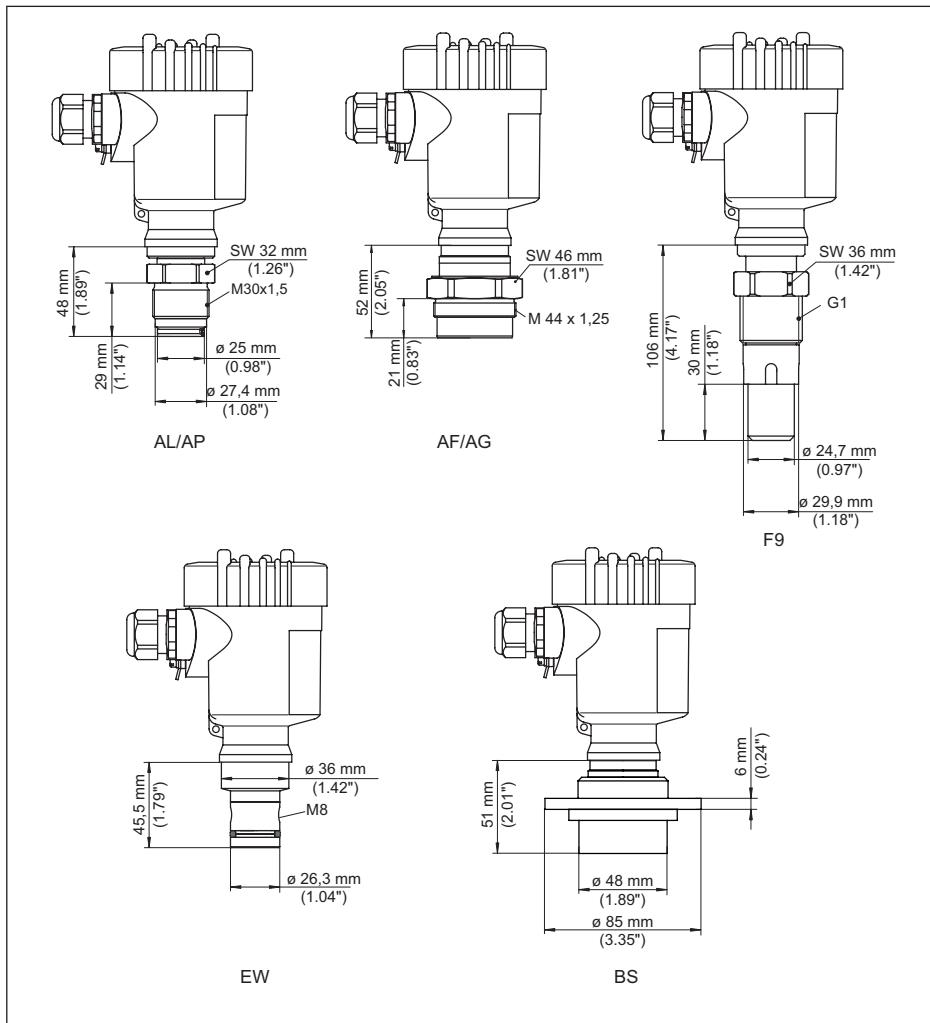
Рис. 66: VEGABAR 82, присоединение с тубусом
