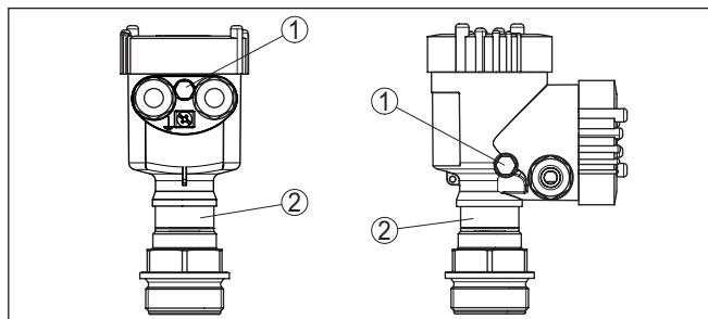
Рис. 14: Положение фильтрующего элемента - газонепроницаемая втулка
