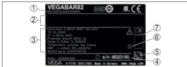
Рис. 1: Данные на типовой табличке устройства (пример)
