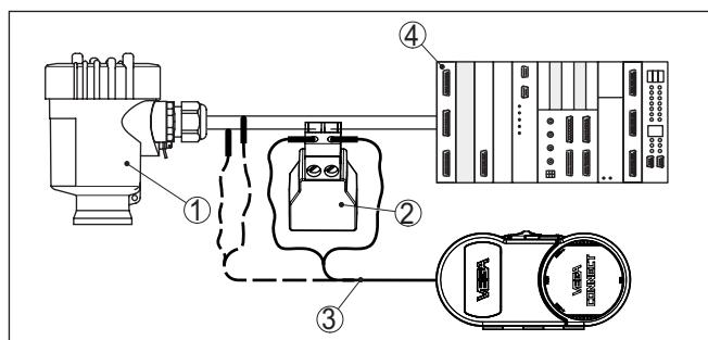
Рис. 44: Подключение ПК к сигнальному кабелю через HART
