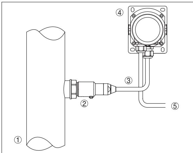
Рис. 20: Расположение рабочего узла и выносного корпуса
