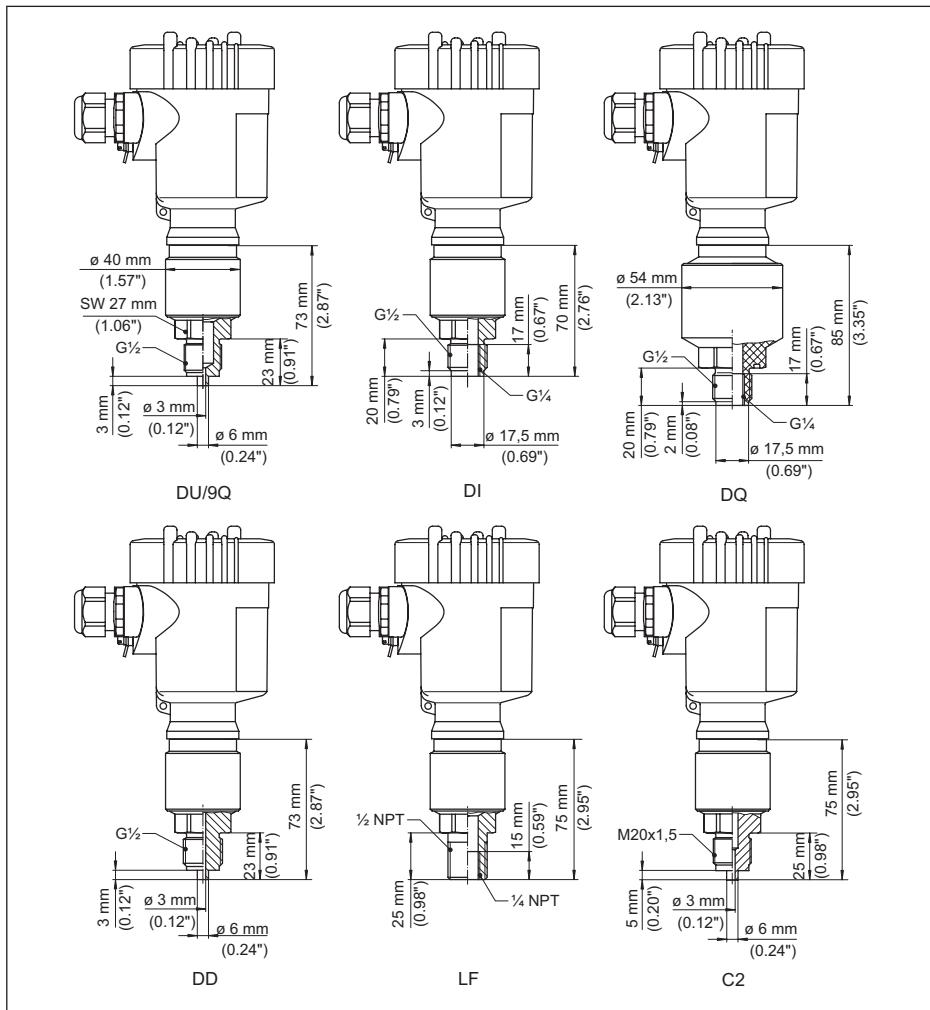
Рис. 62: VEGABAR 82, резьбовое присоединение, не заподлицо
