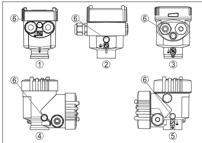
Рис. 12: Позиция фильтрующего элемента
