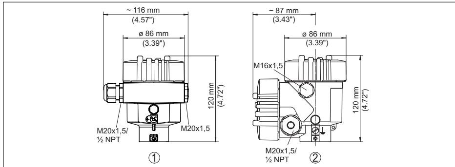
Рис. 56: Корпуса в исполнении IP66/IP68 (0,2 bar), (с установленным модулем индикации и настройки корпус выше на 18 мм/0.71 in)
