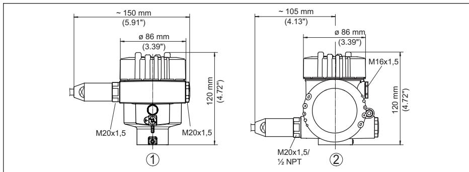
Рис. 57: Корпуса в исполнении IP66/IP68 (1 bar), (с установленным модулем индикации и настройки корпус выше на 18 мм/0.71 in)
