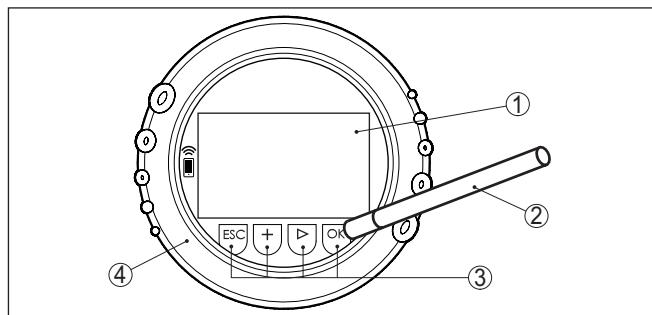
Рис. 41: Элементы индикации и настройки - настройка посредством магнитного карандаша
