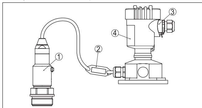
Рис. 21: Комбинация рабочего модуля и выносной электроники
