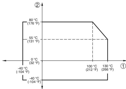
Рис. 52: Температурное снижение параметров VEGABAR 82, исполнение до +130 °C (+266 °F)
