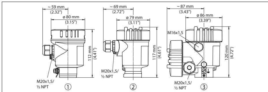
Рис. 58: Корпуса в исполнении IP66/IP68 (0,2 bar), (с установленным модулем индикации и настройки корпус выше на 9 mm/0.35 in или 18 mm/0.71 in)
