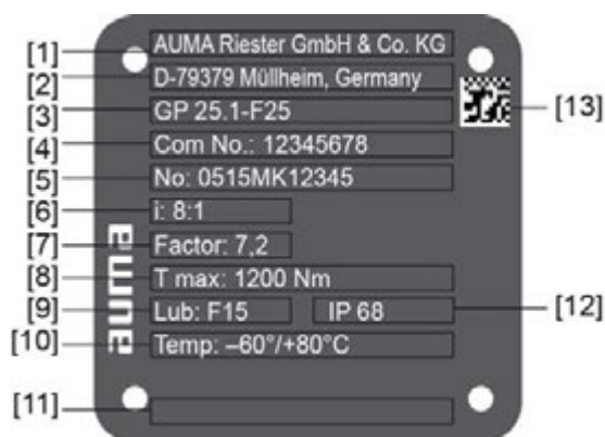
Рис. 2: Заводская табличка редуктора (пример GP 25.1)
