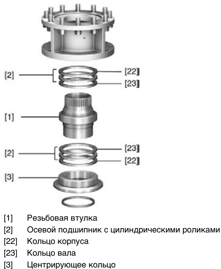
рис. 9: Конструкция соединительной муфты А, пример А 48.2
