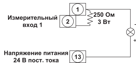
Подключение источника питания датчика
